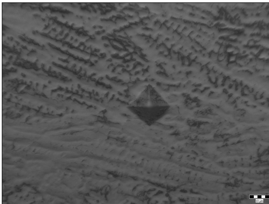
Obr.5.18 Detail vpichu mikrotvrdosti dle Vickerse ve zvětšení 500x. Leptáno 2-2-1.
