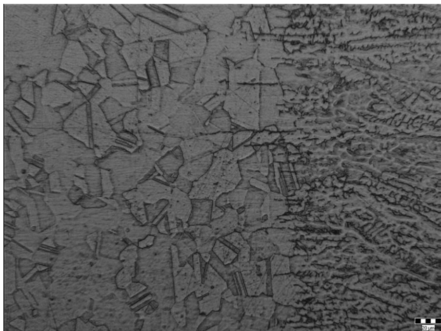
Obr. 5.10 Mikrostruktura vzorku A ve zvětšení 200x. Leptáno 2-2-1.
