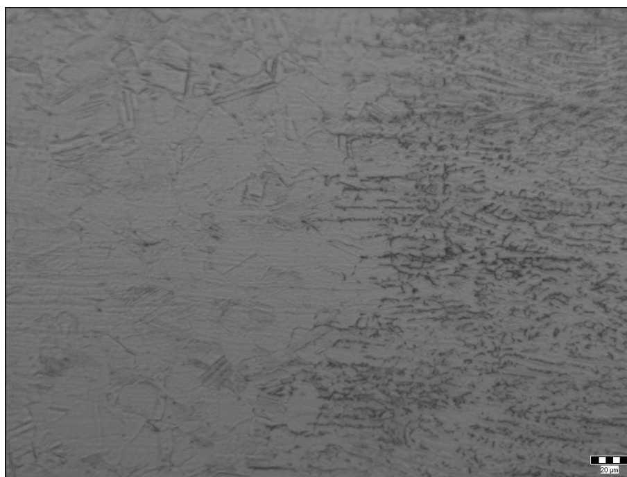
Obr.5.14 Mikrostruktura vzorku AE2 ve zvětšení 200x. Leptáno 2-2-1.
