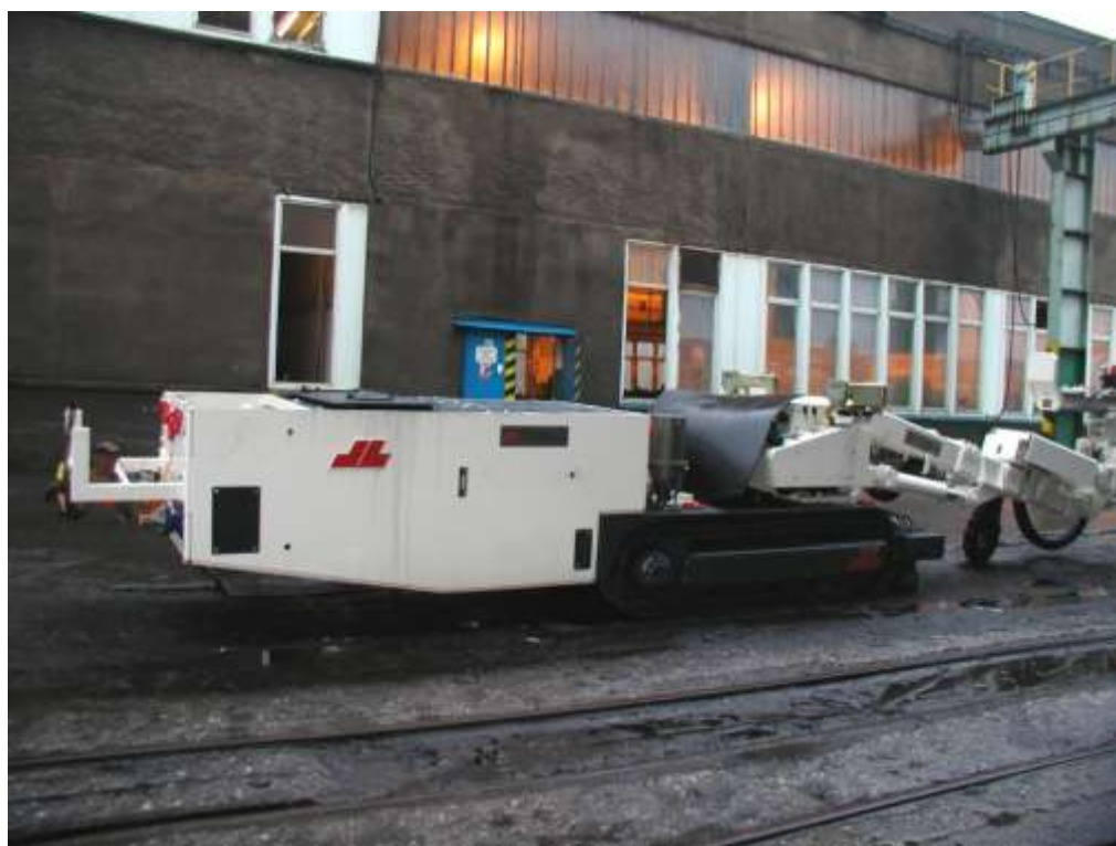
Obr. 10 Vrtací souprava DH-DT1 (BTRL1) firmy Deilmann-Haniel mining systems, před dílnou centrální strojní údržby Dolu Paskov, závod Staříč. Foto: V. Halfar
