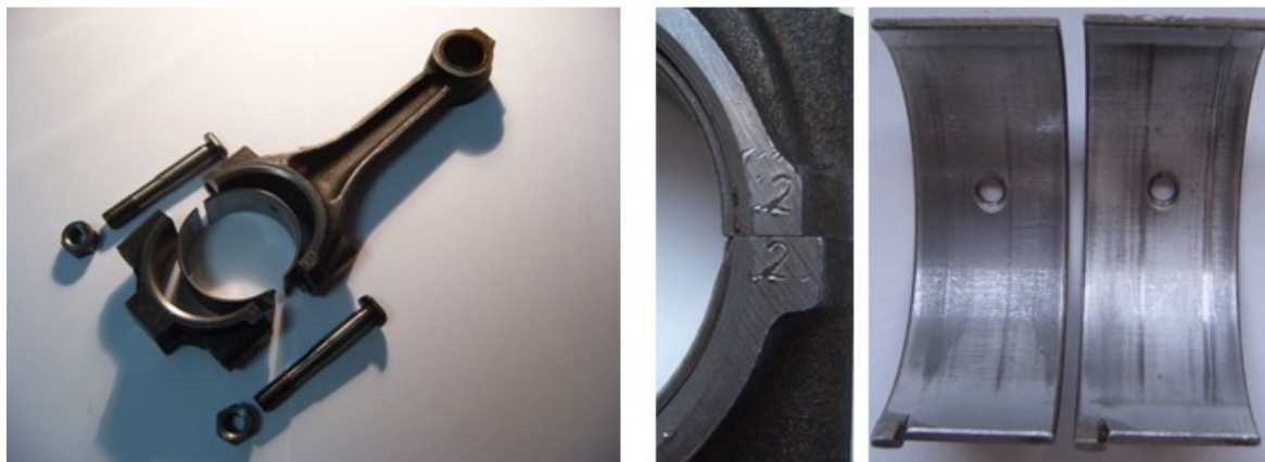
Obr. č. 19: Fotografie řešené ojnice v rozloženém stavu, označení a ložiskové pánve
