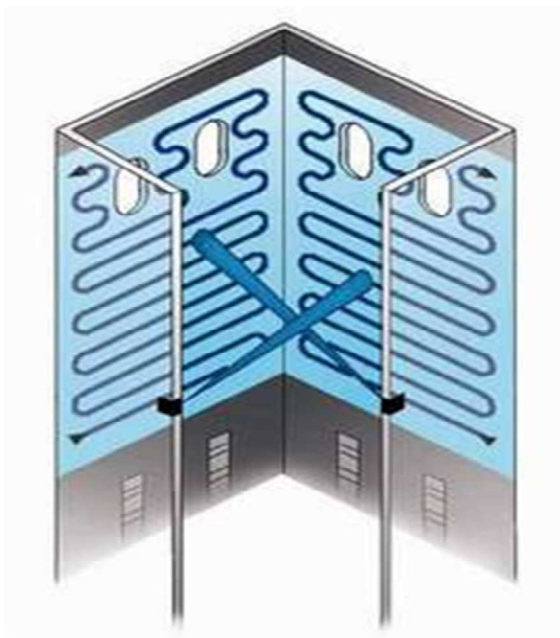
Obr. 6. Ostřikování membránových stěn 1
