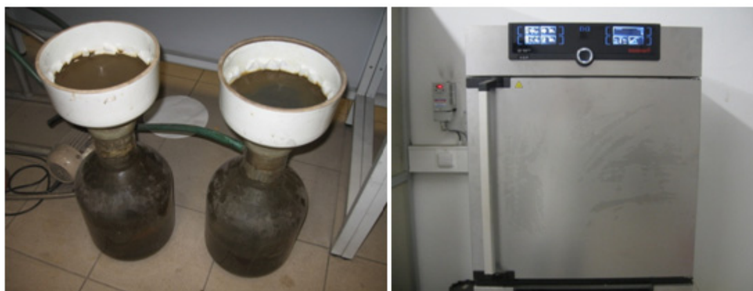
Obrázek 10: Vlevo: filtrace vzorku; vpravo: horkovzdušná sušárna [foto autor]
