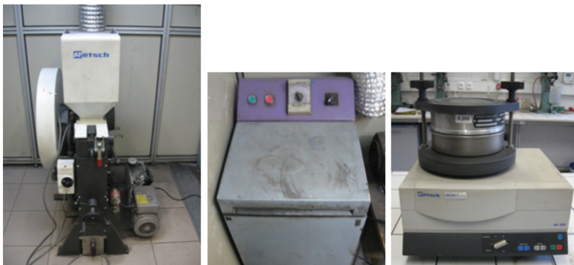
Obrázek 7: Zleva: čelistový drtič, vibrační mlýn, vibrační třídič [foto autor]
