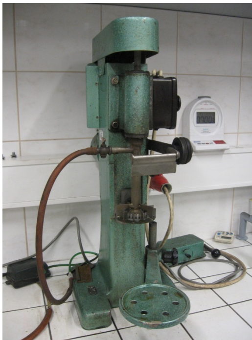
Obrázek 9: Pneumaticko-mechanické flotační zařízení VRF - 1 [foto autor]
