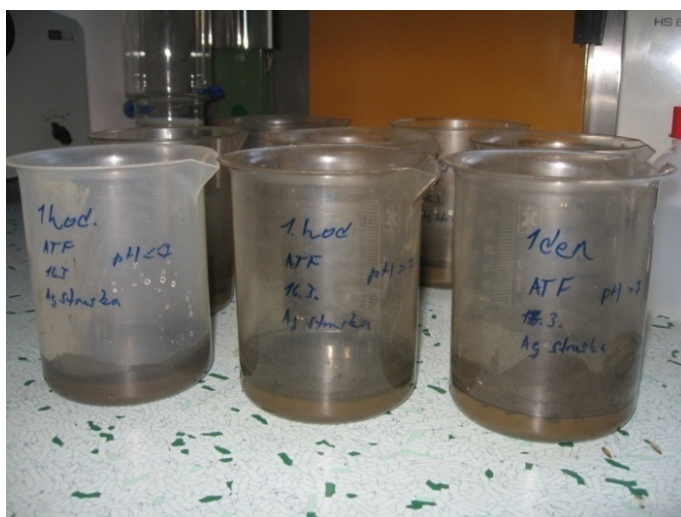
Obrázek 8: Loužení stříbronosné strusky [foto autor]
