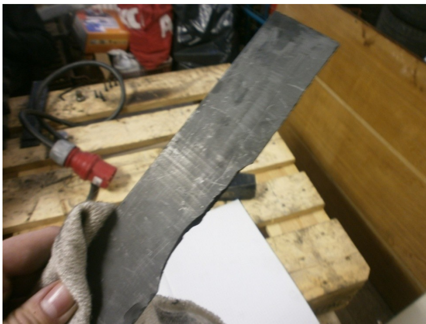
Obr. 25 Velmi poškozená lopatka
