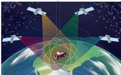
Figura 1.22 Constelación satelital para el GPS.
