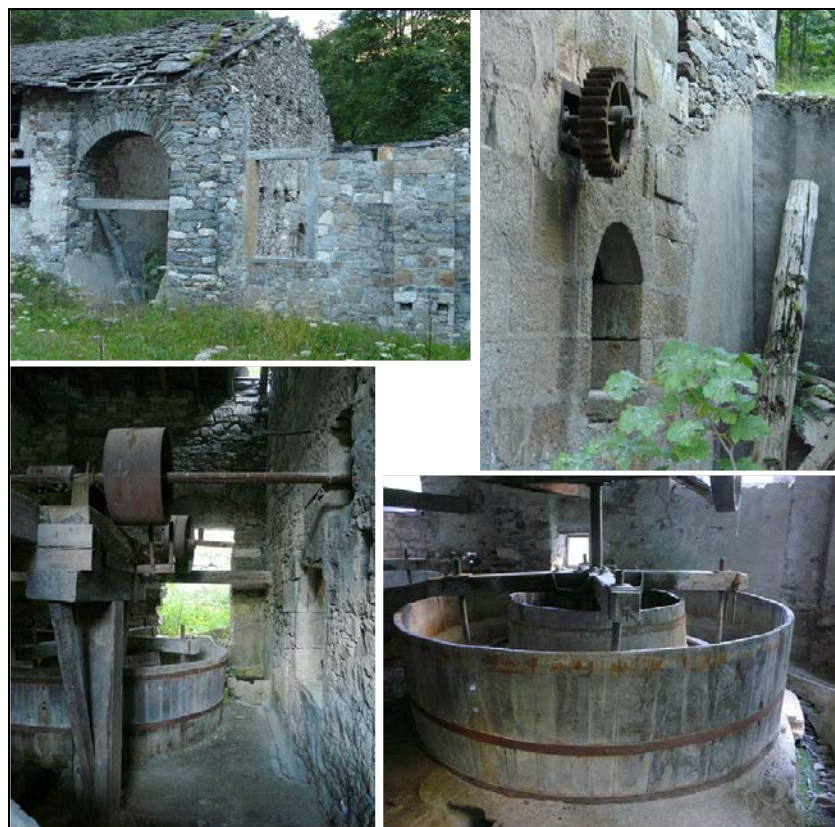
Figura 10 - Alagna: quanto resta della 'fabbrica di San Lorenzo', con le macine installate alla fine dell'Ottocento dalla 'Monte Rosa Gold Mining Company' (immagini da www.in-montagna.it )
