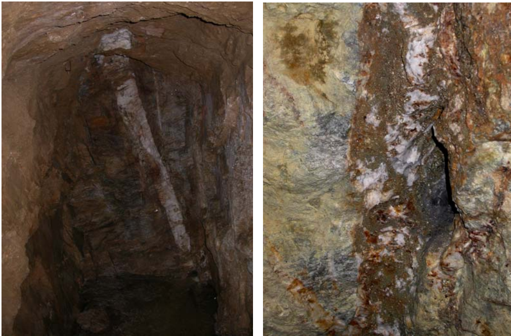
Figura 2 - Gruppo Mont Salé: a sinistra il filone n. 4 incassato negli gneiss del Traversobanco n. 3; a destra mineralizzazione a pirite del filone n. 3 nel Traversobanco Bechaz (foto Cesti)
