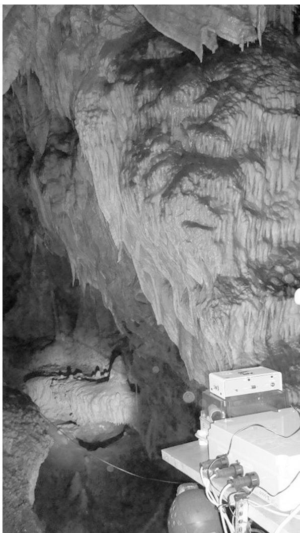
La stazione di rilevamento del radon atmosferico nel Canyon del Torrente
