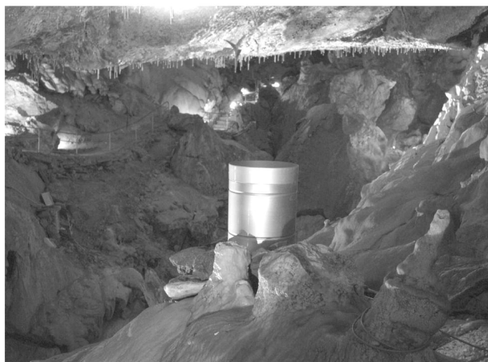
Foto 1 - Pluviografo usato per la misura della portata degli stillicidi
