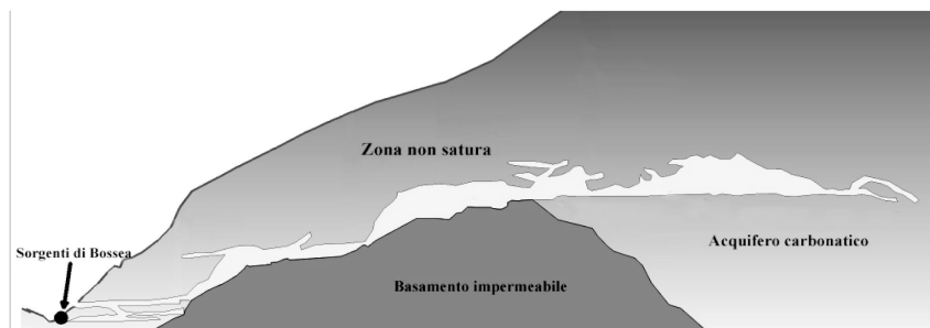
Fig. 1 – Sezione schematica dell'assetto idrogeologico della zona di Bossea
