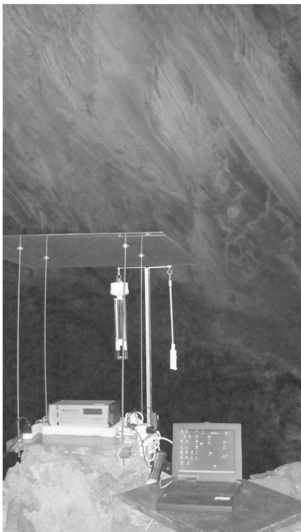
La stazione di rilevamento radon di Sala del Tempio
