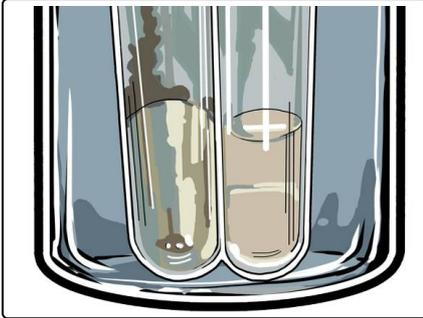
Die Silberspiegelprobe, oder auch Tollens-Probe genannt, weist reduzierende Gruppen nach. Die Reagenz besteht aus Silbernitrat, welchem Ammoniak zugetropft wird, bis sich ein löslicher Silberkomplex bildet. Bei einer positiven Probe wird das Silber reduziert und es entsteht elementares Silber, welches den glänzenden Spiegel erzeugt.
