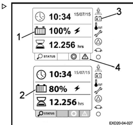
Se la carica della batteria è insufficiente, possono essere visualizzate due avvertenze distinte:
