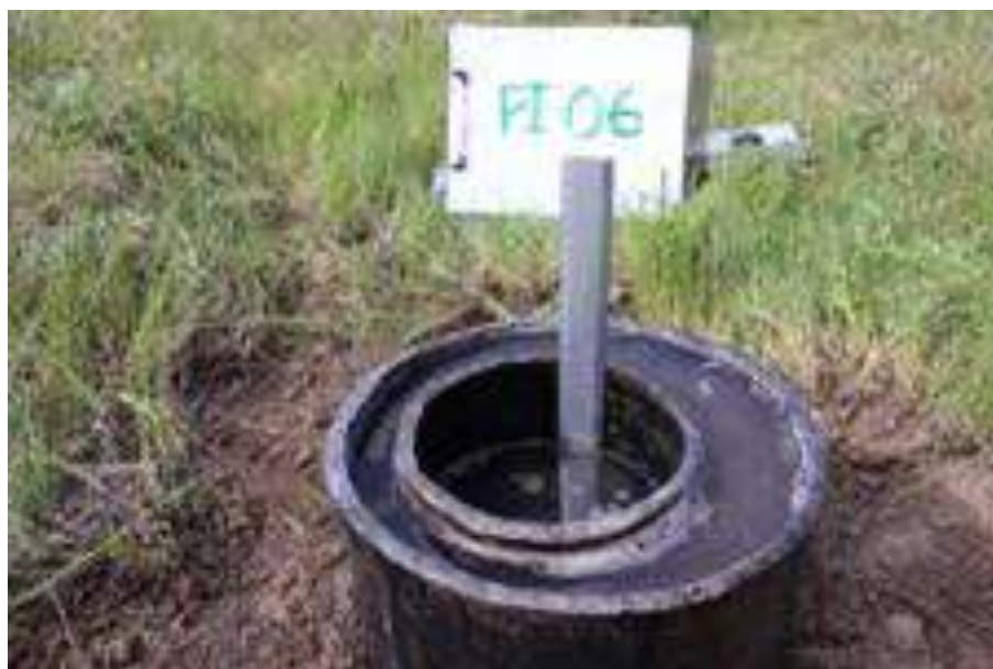
Figura 204. Prueba de infiltración por el método de los anillos en El Judío, Ejido Tlapacoya, Pachuca, Hidalgo.
