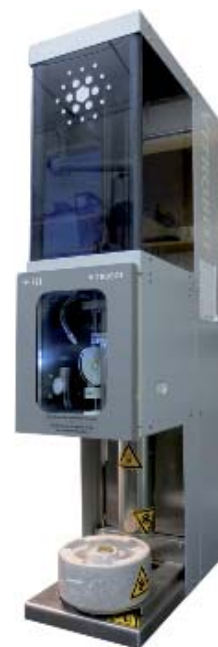
Figura 10.4: Sistema de criofijación de muestras Vitrobot Mark III (FEI). Fuente: http://www.nuance.northwestern.edu
