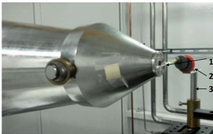
Figura 10.2: Capilar con cromosomas fijado a la plataforma móvil en el interior de la cabina experimental de la línea NCD en ALBA. 1 Capilar que contiene el sedimento de cromosomas, 2 imanes acoplados a la plataforma y 3 plataforma móvil.
