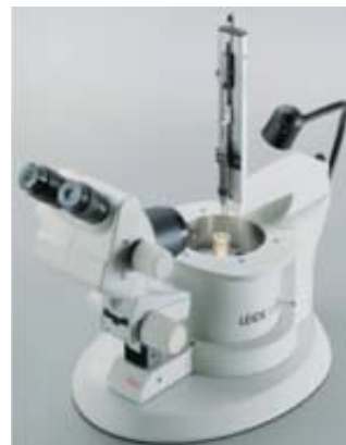
Figura 7.5: Sistema de criofijación de muestras Leica EM CPC. Fuente: http://www.sct.uab.cat/microscopia/es .
