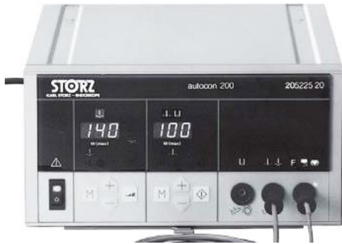
Figura 22. Fuente de diatermia bipolar y monopolar.
