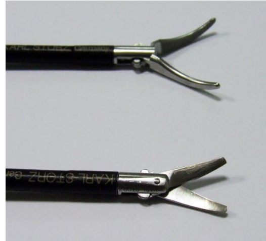
Figura 26. Detalle de las puntas del disector de Maryland y tijera monopolar de 5 mm respectivamente.
