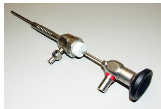
Figura 51. Conjunto de óptica de 2.7 mm introducida en el trocar de 5 mm con una goma reductora de 3 mm. Nótese la holgura entre la óptica y la vaina del trocar.
