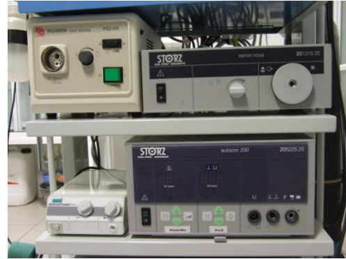
Figura 23. Fuente de luz y fuente de diatermia con sus equipos de reserva.
