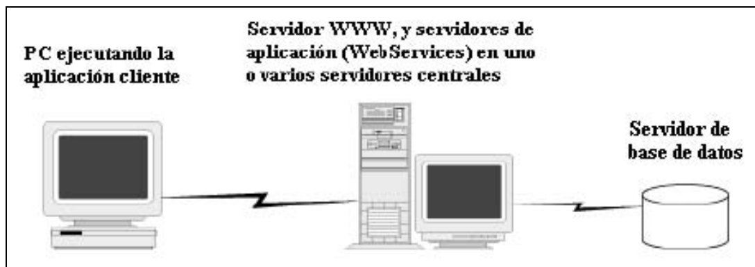
Fig. 1 Esquema de la programación en tres capas
