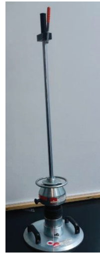
Abbildung 11: Abbildung der genutzten dyna- mischen Fall- platte ohne den Messcomputer. Foto: L. Schütte.
