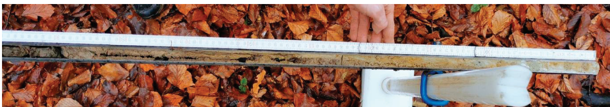
Abbildung 8: Pürckhauer inklusive entnommenen Bodenmaterial. Foto: L. Schütte.
