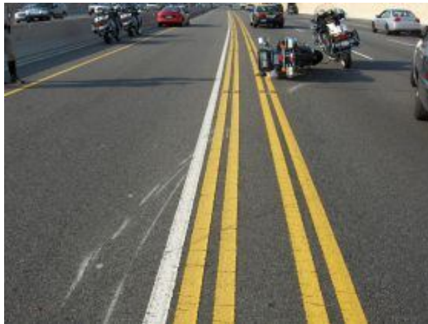
Obr. 5. Stopa dření motocyklu o vozovku
