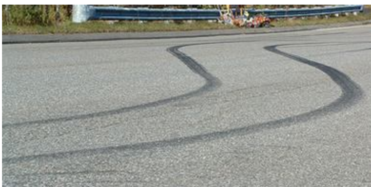
Obr. 4. Stopy smyku osobního vozidla
