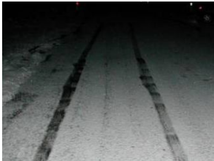
Obr. 8. Stopy vozidla vybaveného systémem ABS
