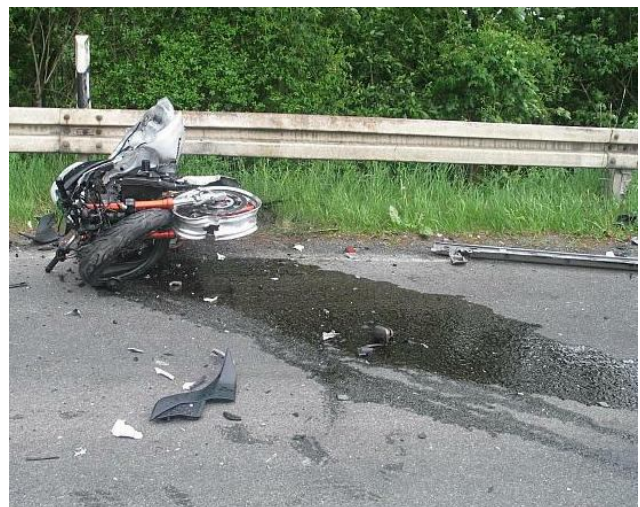
Obr. 7. Stopa po úniku provozní kapaliny
