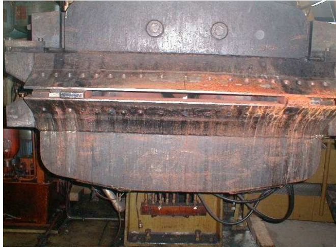
Obrázek č. 13: hlava vytlačovacího stroje s úzkou štěrbinou
