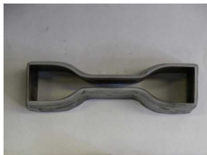
Obrázek č. 34: nůž na vysekávání vzorků pro tahovou zkoušku
