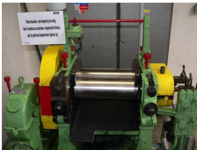
Obrázek č. 31: laboratorní dvouválec 50x20 cm
