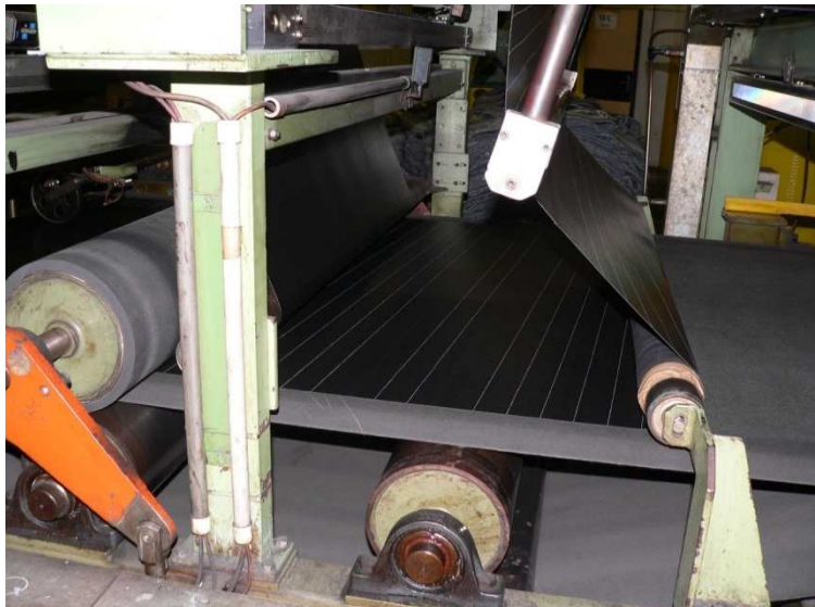
Obrázek č. 20: spojování sdruženého polotovaru s vnitřní pryží (gumou)
