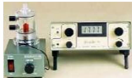
Figura 37 Electrodo de oxígeno tipo "Clark" (Hansatech) empleado en los experimentos de respiración.
