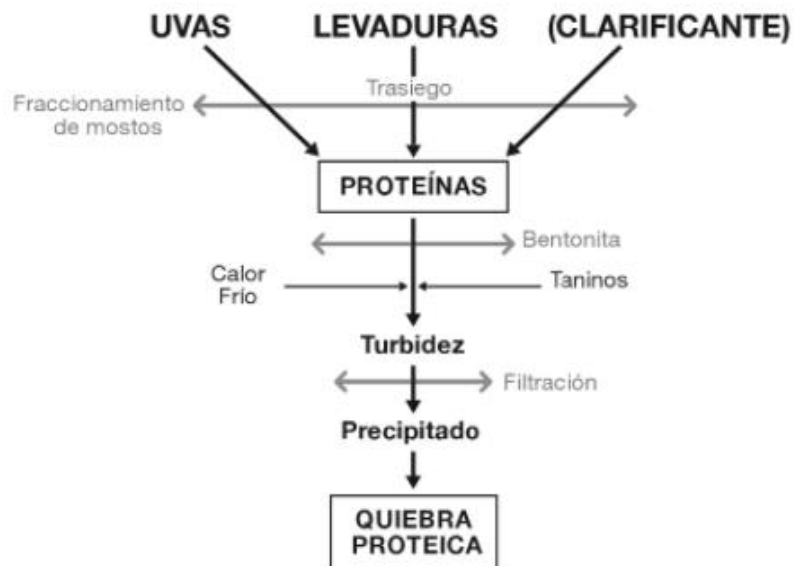
Figura 3. Esquema de formación de quiebra proteica en el vino. Tomado de Enología Práctica (p. 231), por J. Blouin, & Peynaud, 2004, Editorial Mundi-Prensa.
