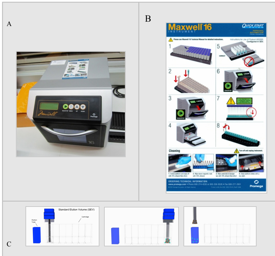
Figura 13. A. Maxwell 16 System. B. Guía de utilización del Maxwell 16. C. Esquema detalle de la extracción de ADN.
