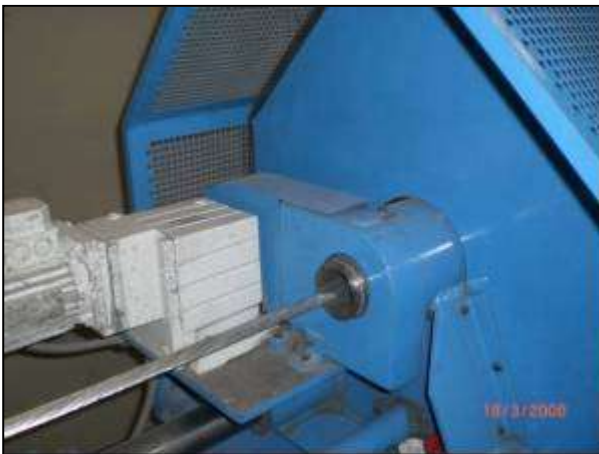
Φωτογραφία 4.2.2.11-1: Οπλισμός καλωδίου με ατσαλόσυρμα
