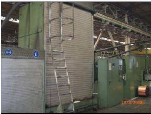
Φωτογραφία 4.2.2.2-1: Ανόπτηση σύρματος χαλκού
