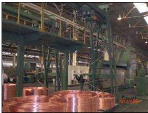
Φωτογραφία 4.2.2.1-1: Είσοδος πρωτ. ύλης- χαλκού στις μηχανές συρματοργίας – Αρχή παραγωγικής διαδικασίας
