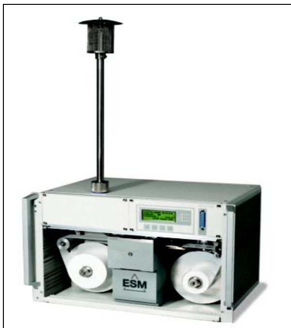
Σχήμα 8.2: Συσκευή ESM Andersen FH 62 I-R Particulate Monitoring Instrument για την καταγραφή ωριαίων συγκεντρώσεων αιωρούμενων σωματιδίων PM10.
