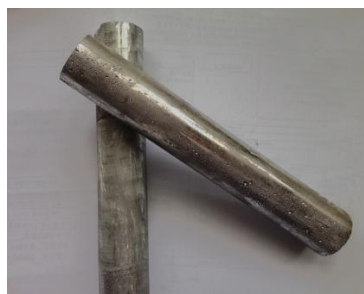
Figura 18 Lingote tipo bulk de \text{Bi}_2\text{Te}_3 y \text{Sb}_2\text{Te}_3
