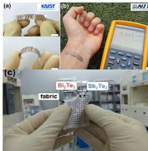
Figura 17 a-b) Demostración de generador TE de banda flexible para recolectar el calor de la piel. c) módulo flexible de fibra de vidrio de 196 puntos de \text{Bi}_2\text{Te}_3 y \text{Sb}_2\text{Te}_3 [40]
