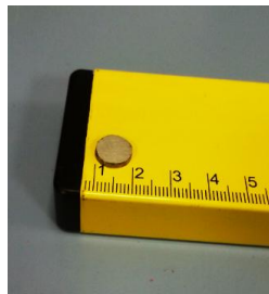
Figura 29 Pellet de \text{Bi}_2\text{Te}_3 obtenida por hot-press
