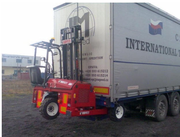
Obrázek č. 8: Umístění vysokozdvizného vozíku na zádi vozidla
