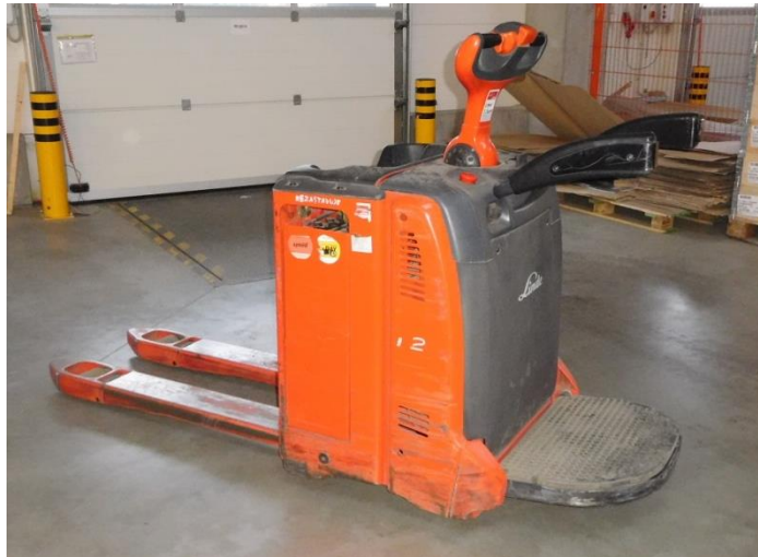
Obrázek 21 Nízkozdvižný vozík T20, model AP (Autor, 2017)
