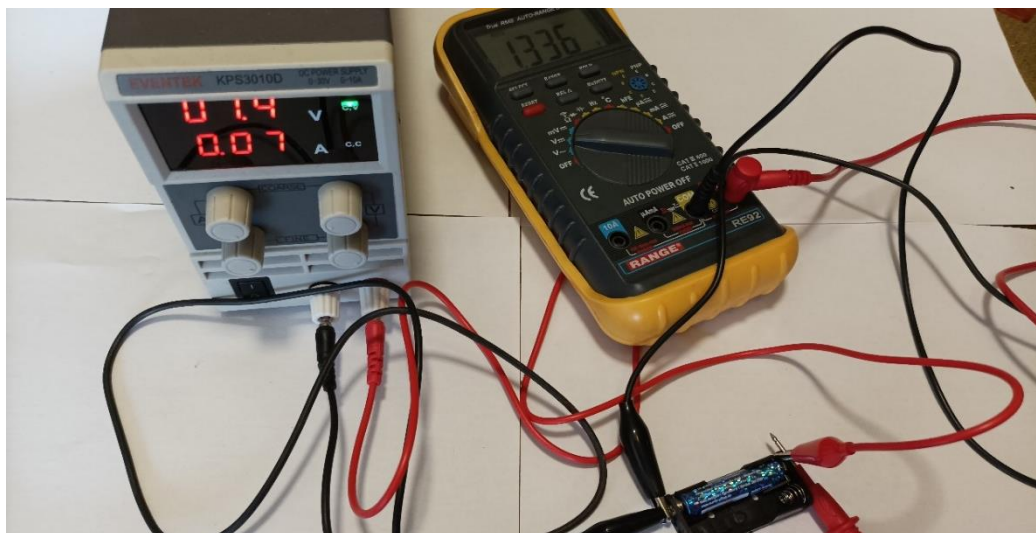
Obrázek 30 - Ukázka nabíjení AAA Ni-MH akumulátoru
