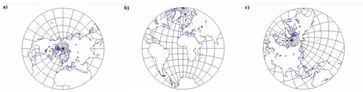
Figura 4.13 - Projeção Azimutal Estereográfica, três casos: a) normal ou polar; b) transversal ou equatorial; e c) oblíquo
