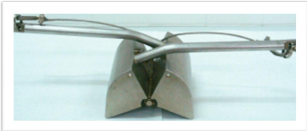
Figura 4. Apresentação da estrutura do Amostrador Van Veen. Fonte: Foto de César Augusto M. Roda/CETESB, 2011.
