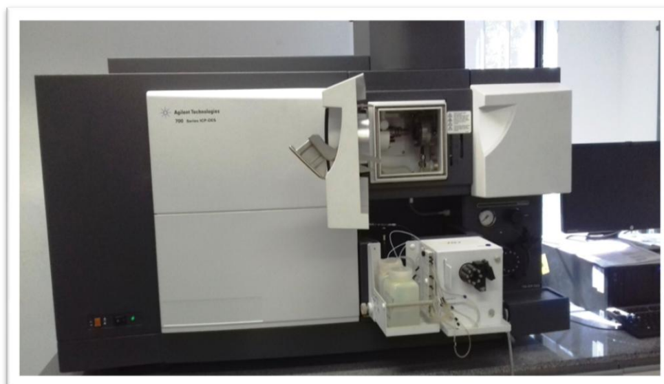
Figura 6. Imagem do espectrômetro 700 Series ICP-OES, objeto utilizado nas análises de concentrações de elementos traço no presente estudo.
