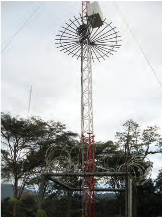
Figura 11. Torre de flujo y calicata para evaluación continua de interacciones atmosféricas en sistemas agroforestales y a pleno sol. Fotos: Proyecto MACACC, 2015
