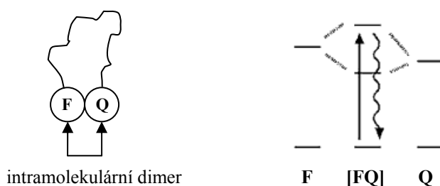
Obr. č. 2.: Znázornění statického zhášení
