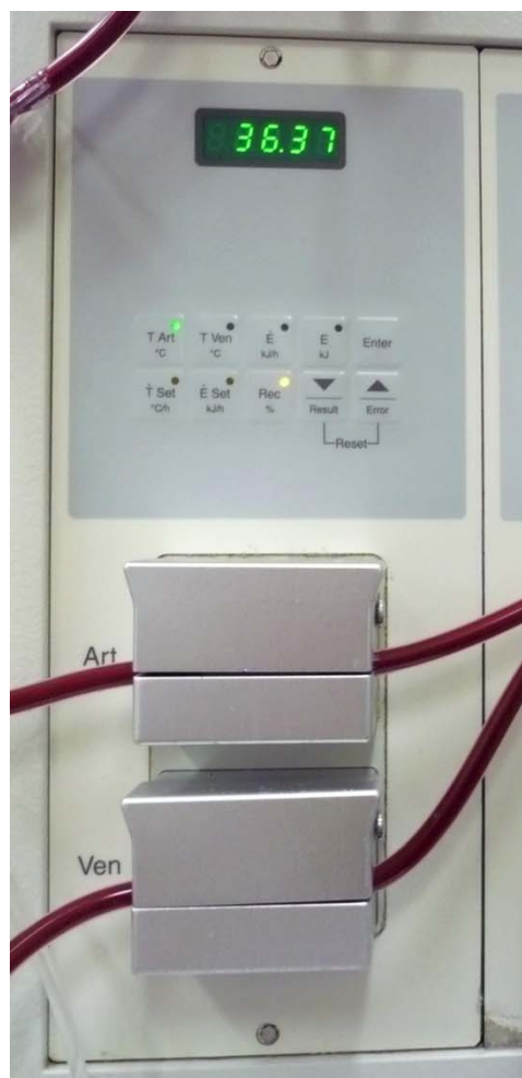
Obr. 3.4.1.2.1: Blood Temperature Modul zabudovaný v dialyzačním monitoru firmy Fresenius.
