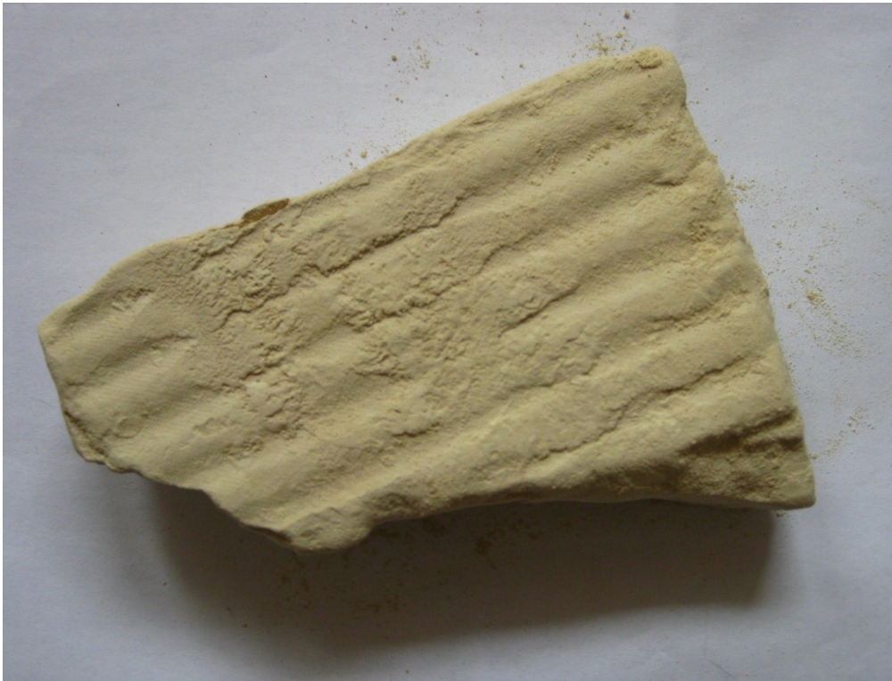
Obr. 2. Studovaný výplav zpracovaný kalolisem (autor)
