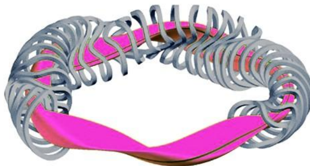
Obr. 14. Schéma komory stelarátoru Wendelstein. Poloidální cívky mají pro požadovaný profil magnetického pole velmi komplikovaný tvar. Převzato z [32].
