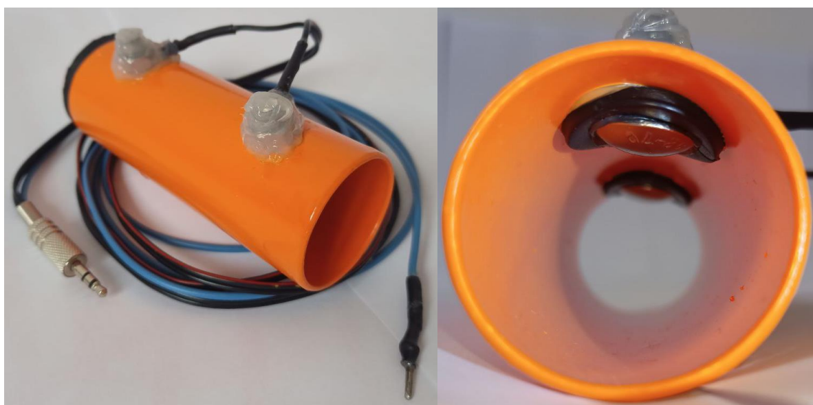
Obr. 4.6: Trubka s nainstalovanými elektrodami, referenční elektroda a konektor Jack pro jejich připojení
