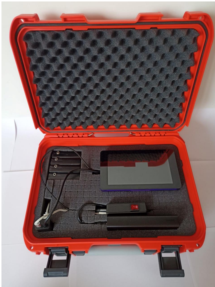
Obr. 4.11: Realizované přenosné zařízení pro vícekanálový záznam EOD u ryb čeledi Mormyridae
