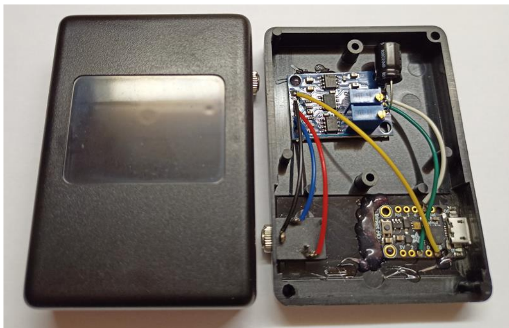
Obr. 4.9: Realizované jednonálové měřicí EOD zařízení
