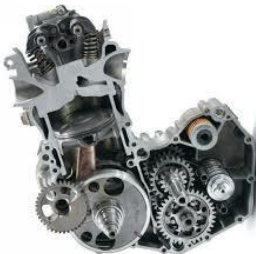
Obrázek 2 - Jednoválcový motor Husaberg týmu TU Brno Racing
