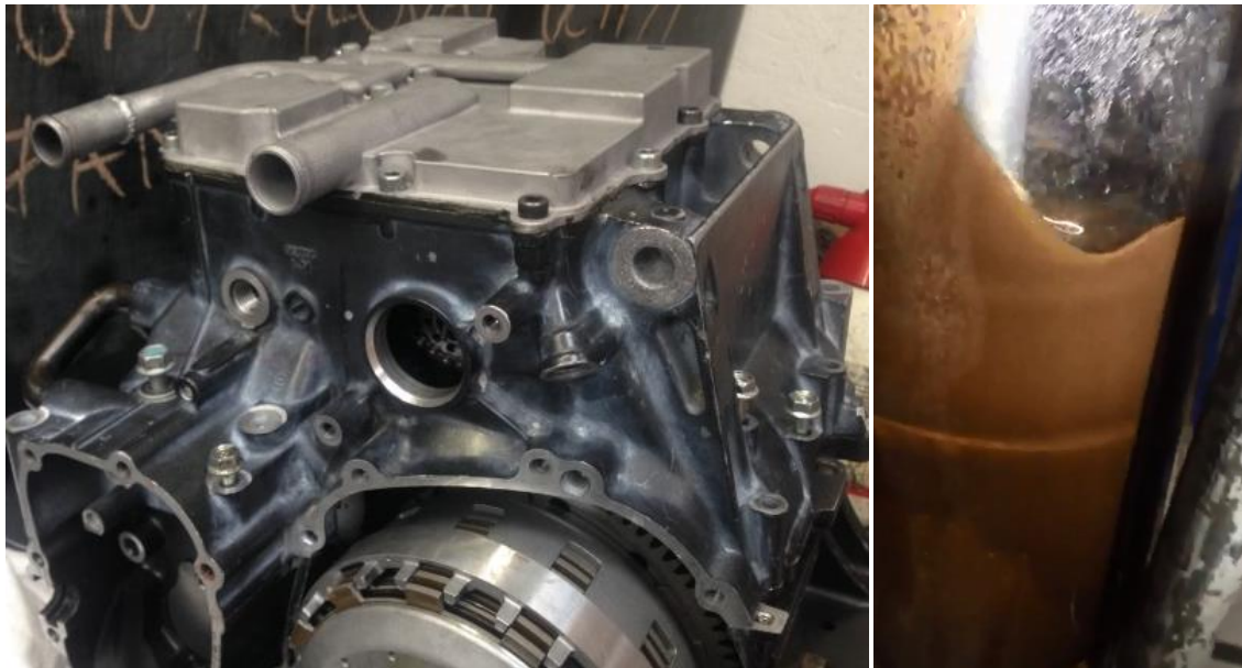
Obrázek 35 - Systém mazání z FS.0X na motoru Yamaha a olej v nádobě za provozu
