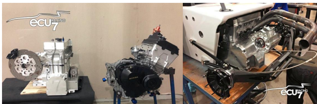
Obrázek 4 - Úprava motoru Honda CBR týmem z Edith Cowan University a jeho zástavba
