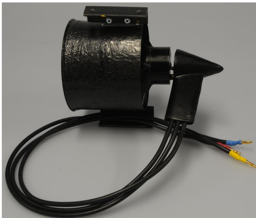
Obrázek 17- dmychadlo s nasazeným kabelovým přechodem
