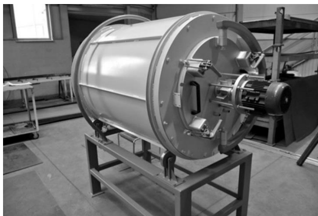
Obrázek 10: Laboratorní zařízení pro testování difuzního zinkování [30]
