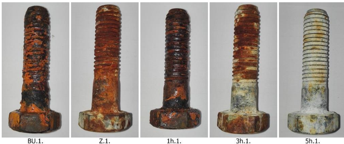
Obrázek 31: Vzorky po 168 hodinách expozice v solné mlze
