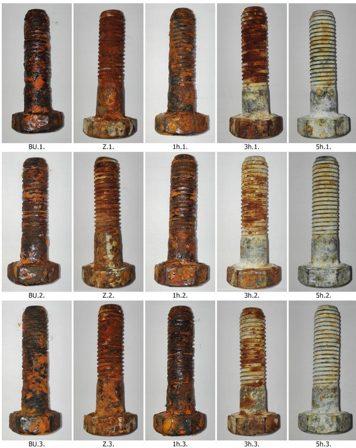
Obrázek 52: Vzorky po 192 hod v korozní komoře
