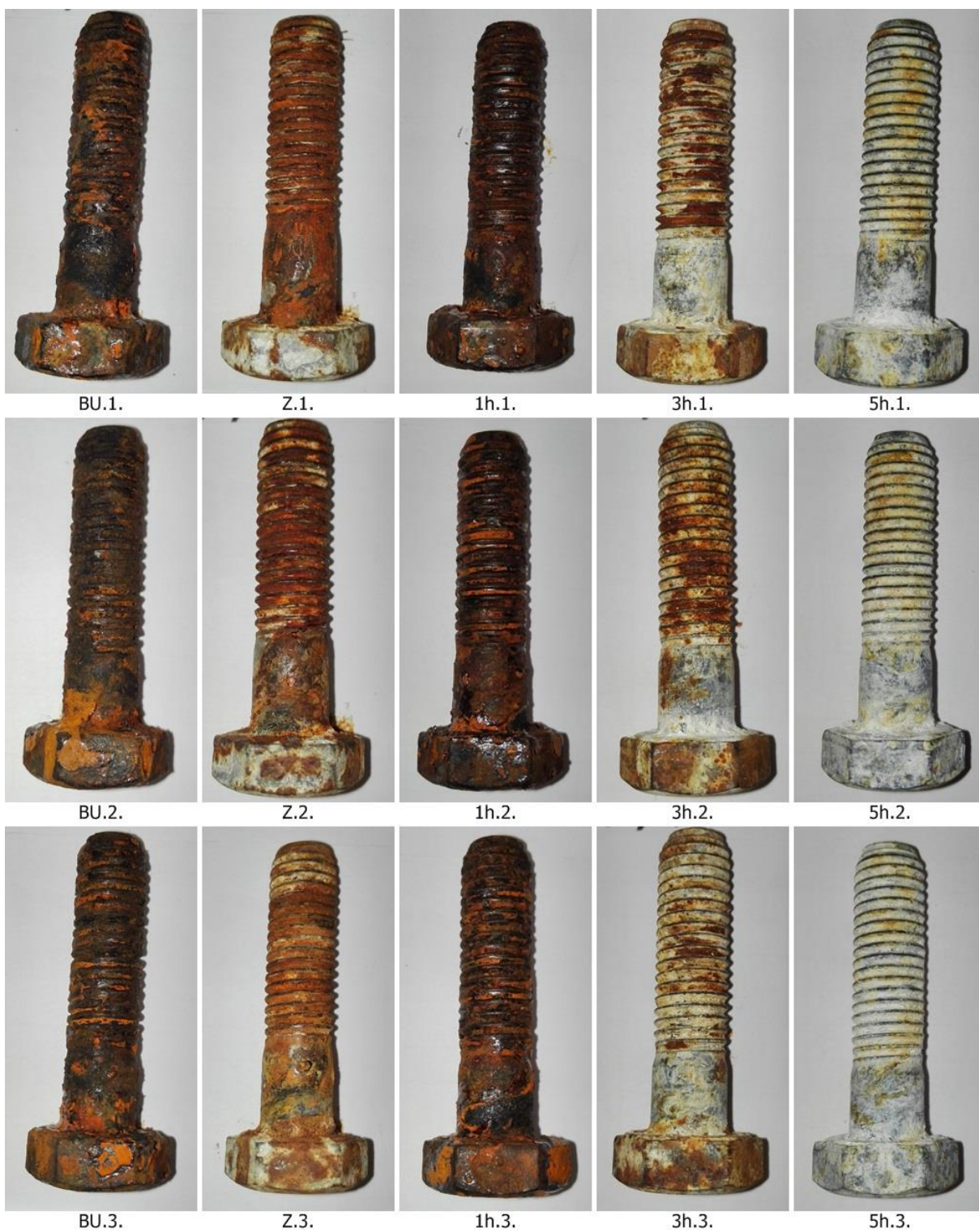
Obrázek 50: Vzorky po 144 hod v korozní komoře
