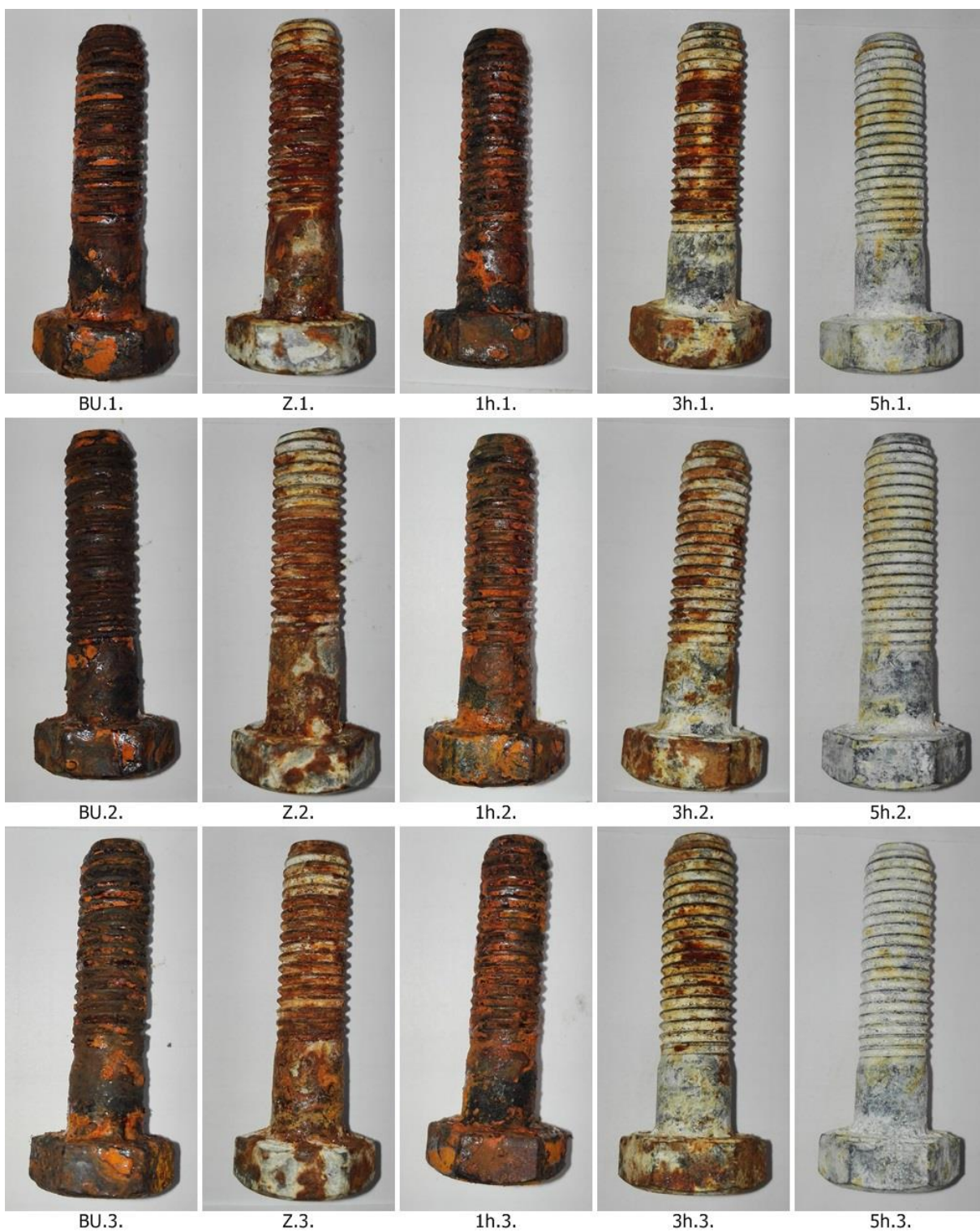
Obrázek 49: Vzorky po 120 hod v korozní komoře
