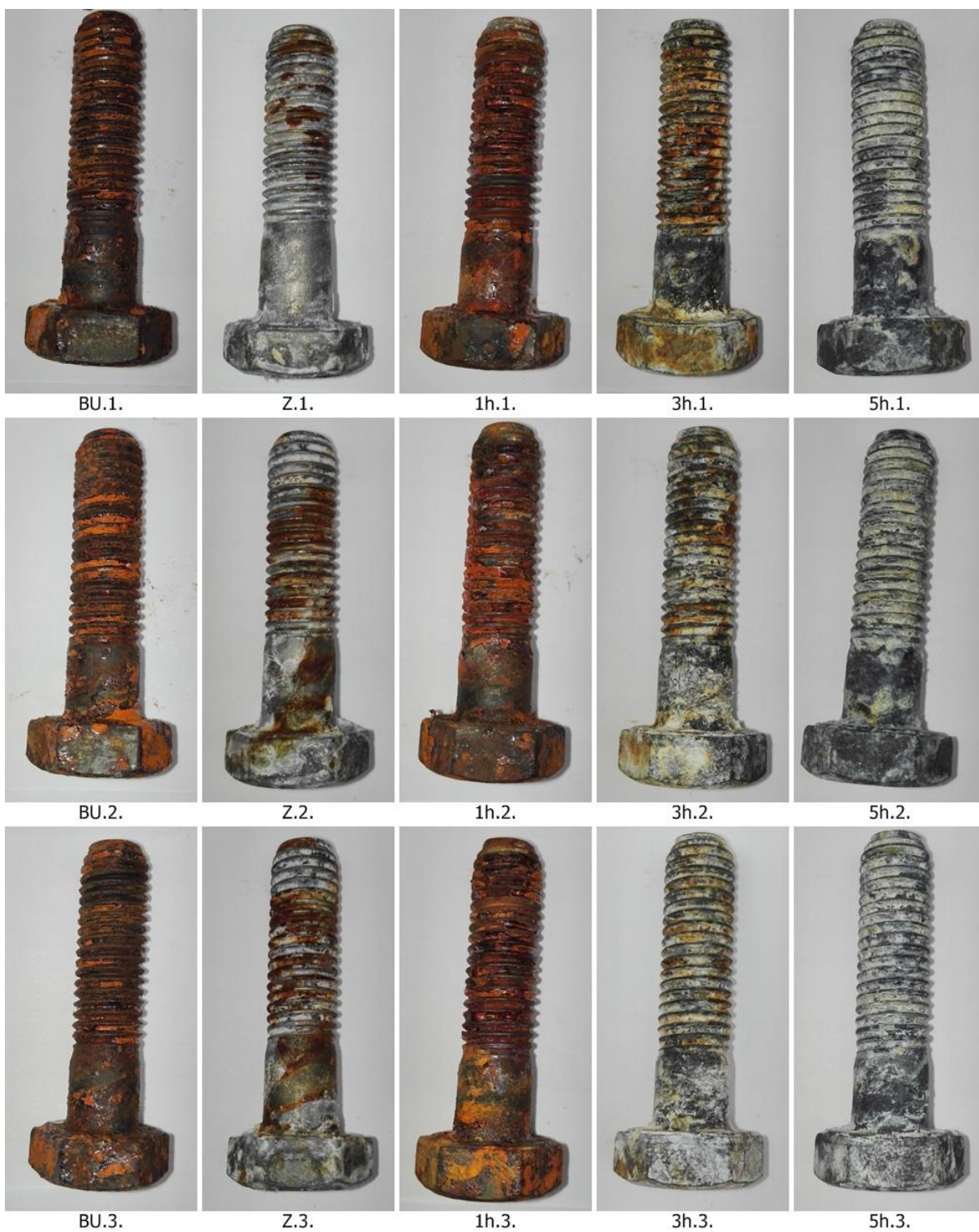
Obrázek 46: Vzorky po 48 hod v korozní komoře
