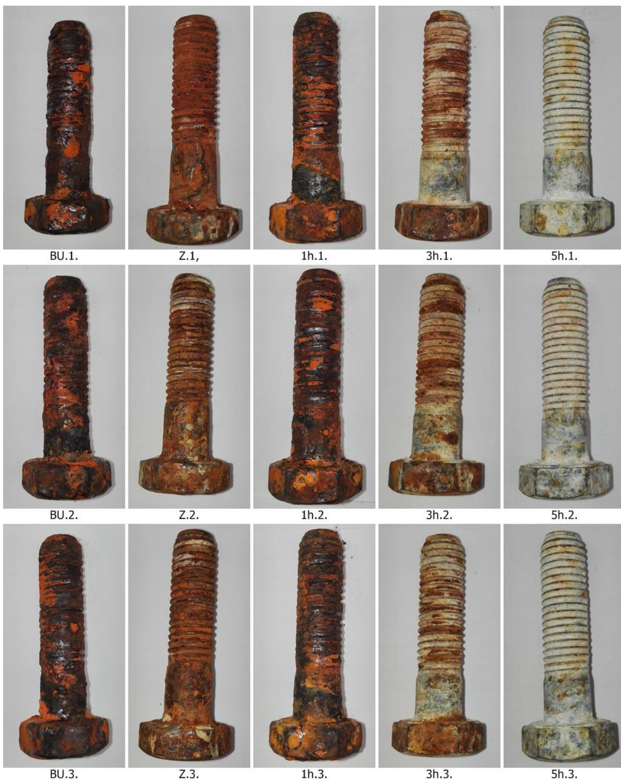
Obrázek 53: Vzorky po 216 hod v korozní komoře
