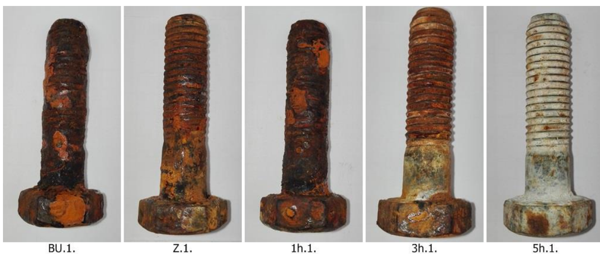
Obrázek 32: Vzorky po 336 hodinách expozice v solné mlze
