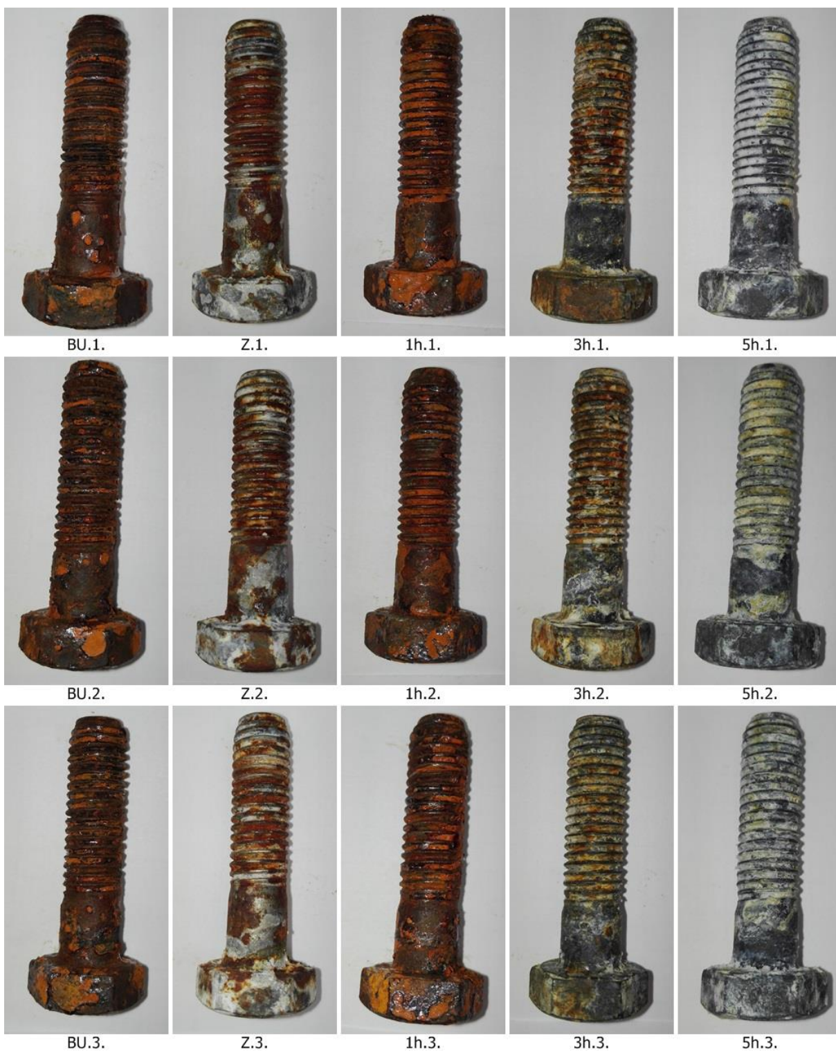
Obrázek 47: Vzorky po 72 hod v korozní komoře
