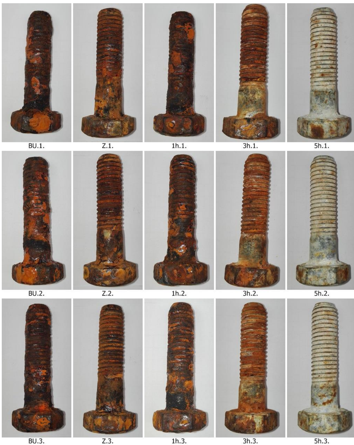
Obrázek 58: Vzorky po 336 hod v korozní komoře
