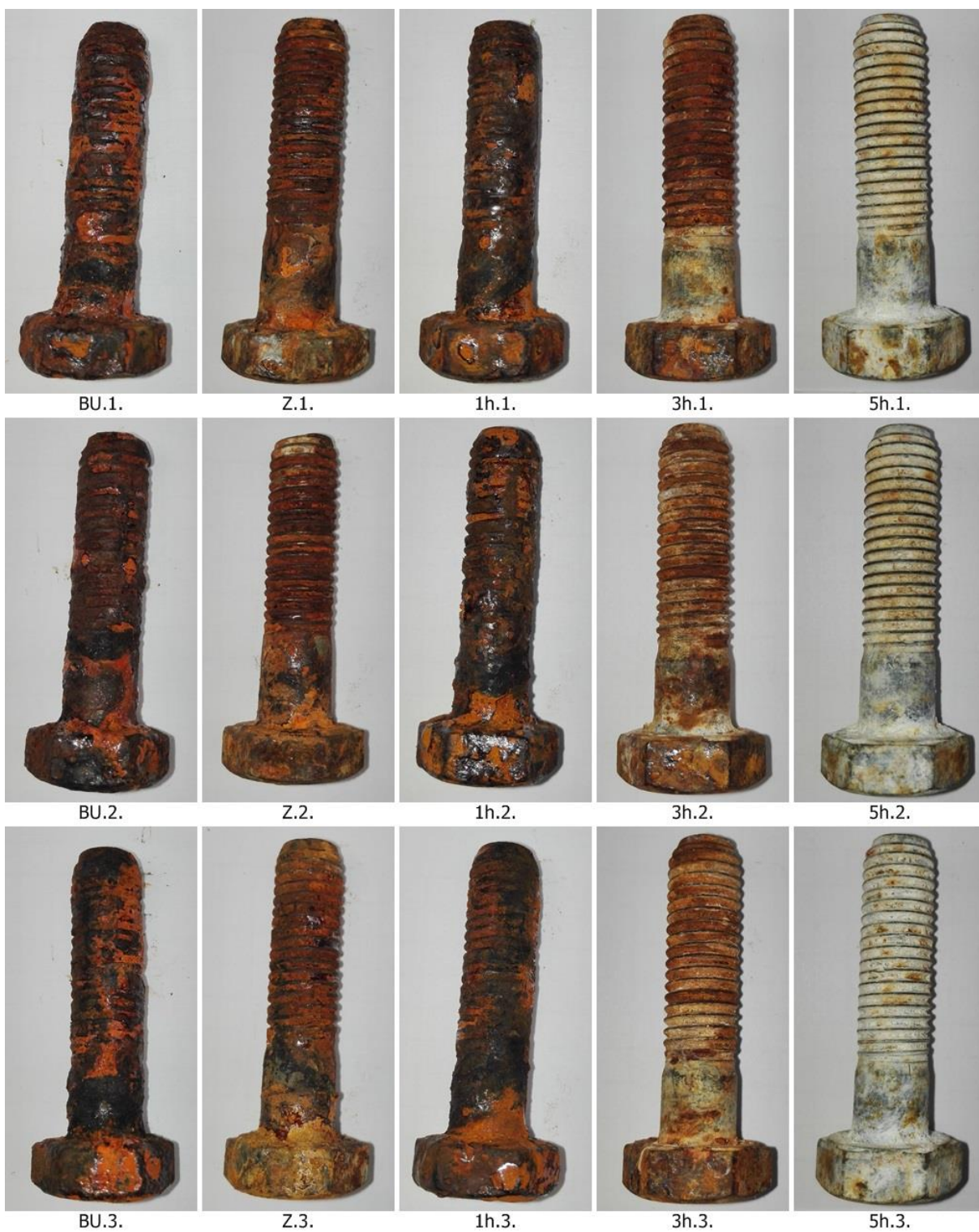
Obrázek 56: Vzorky po 288 hod v korozní komoře
