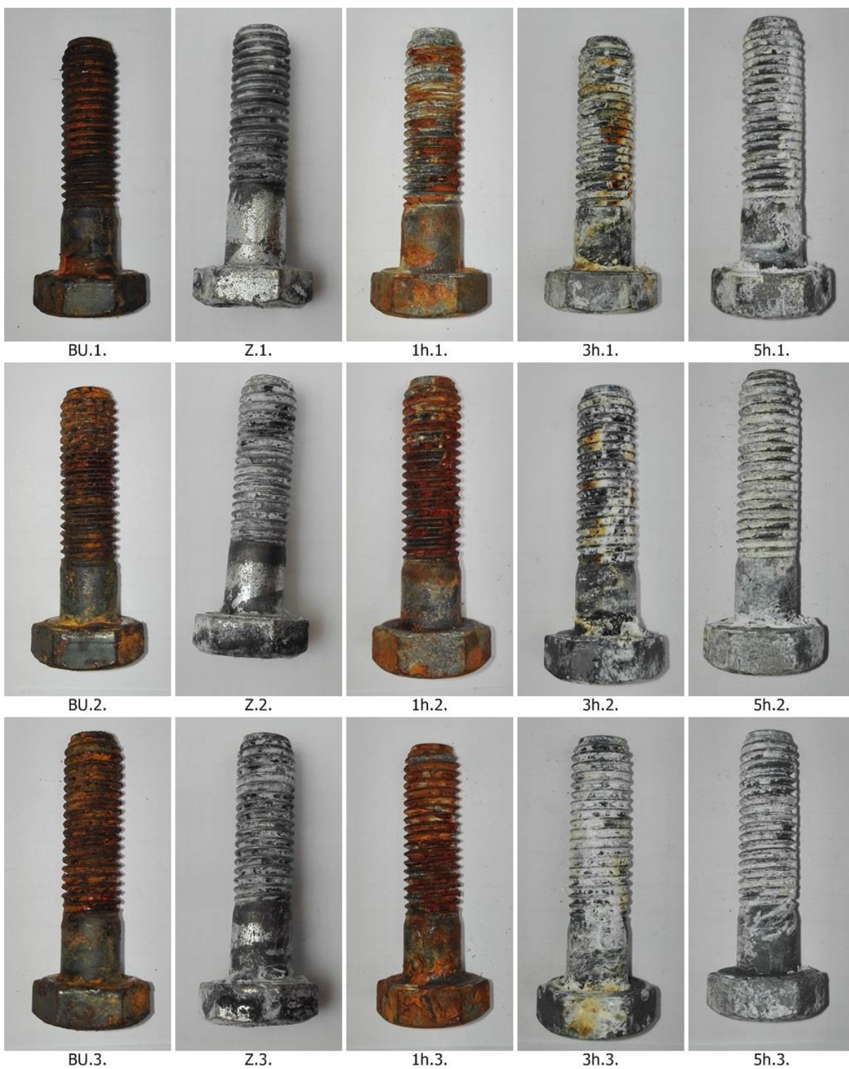
Obrázek 45: Vzorky po 24 hod v korozní komoře
