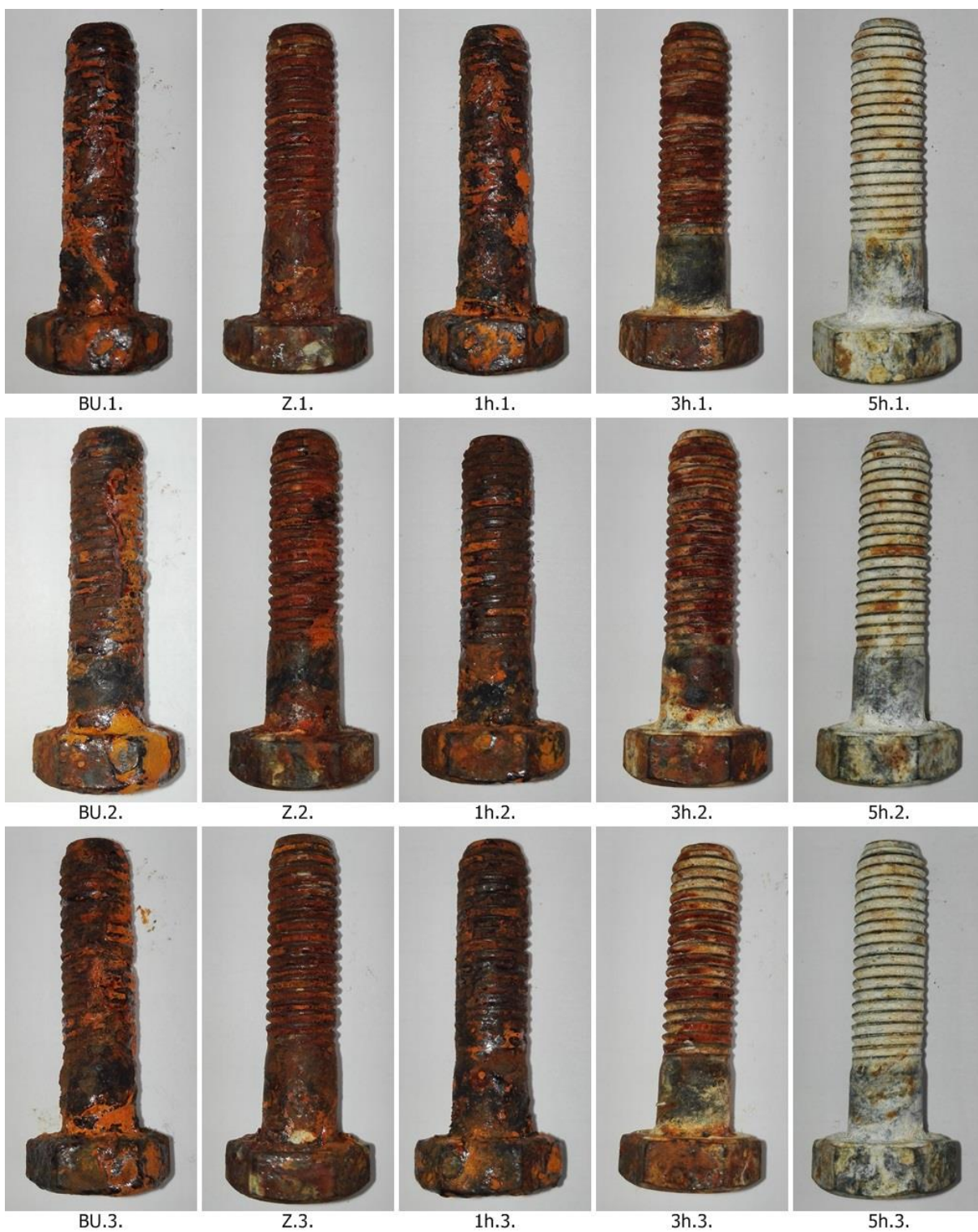
Obrázek 54: Vzorky po 240 hod v korozní komoře
