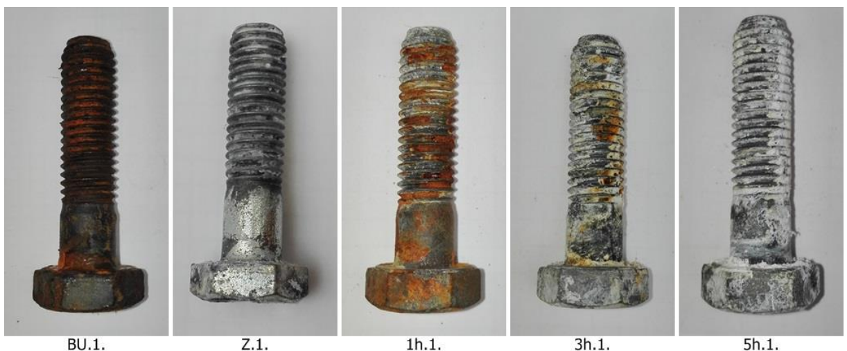
Obrázek 29: Vzorky po 24 hodinách expozice v solné mlze
