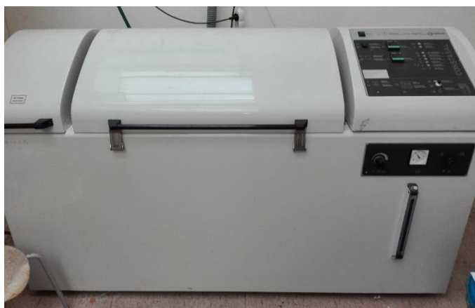
Obrázek 27: Korozní komora Liebisch S 400 M-TR
