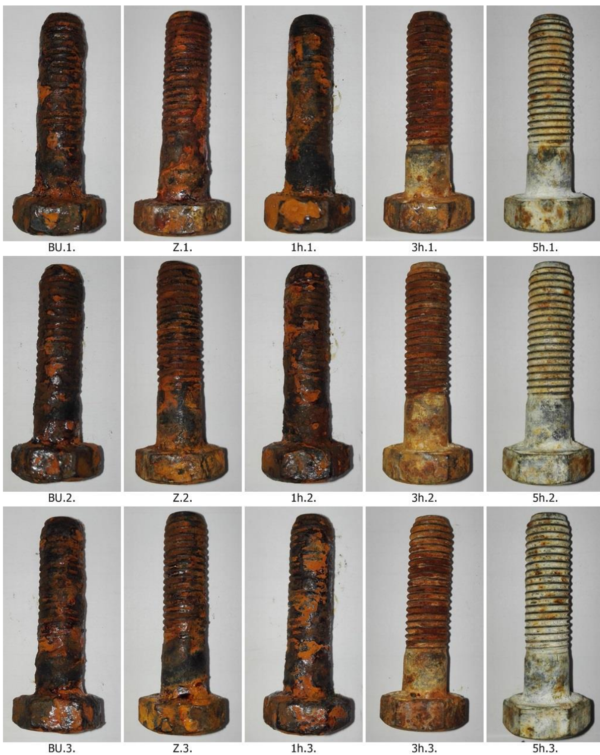
Obrázek 57: Vzorky po 312 hod v korozní komoře
