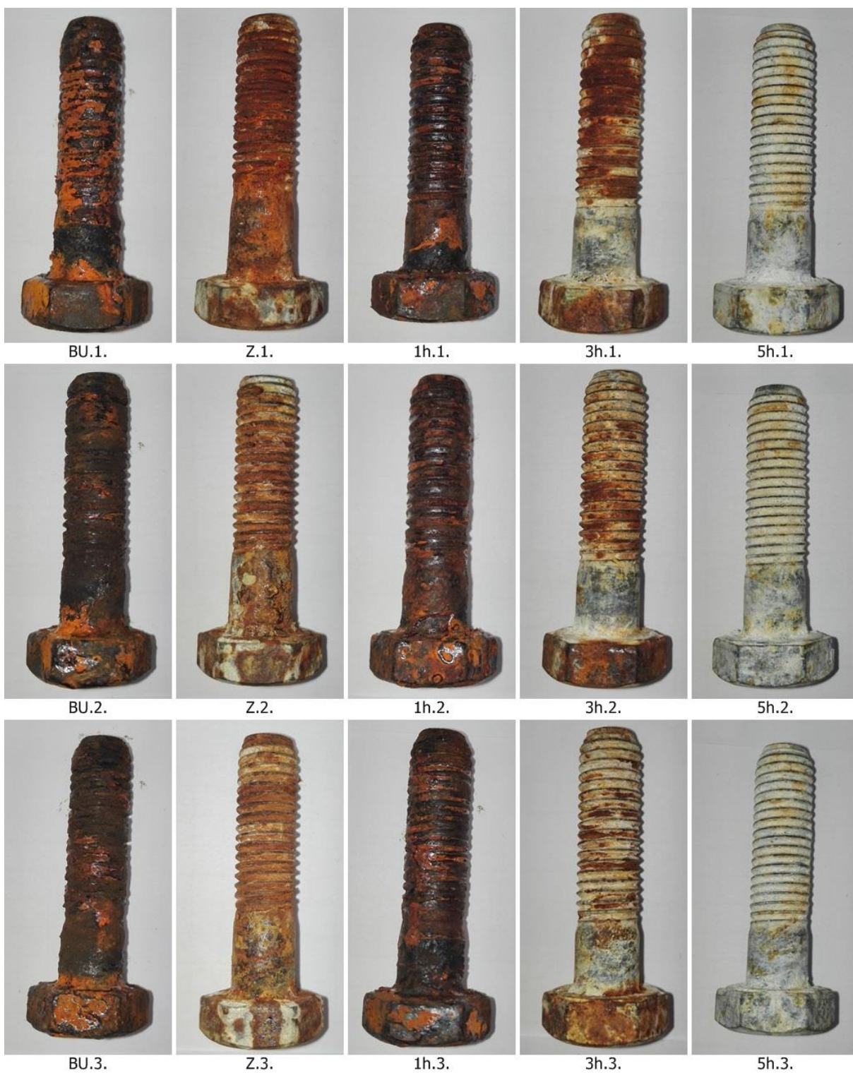
Obrázek 51: Vzorky po 168 hod v korozní komoře
