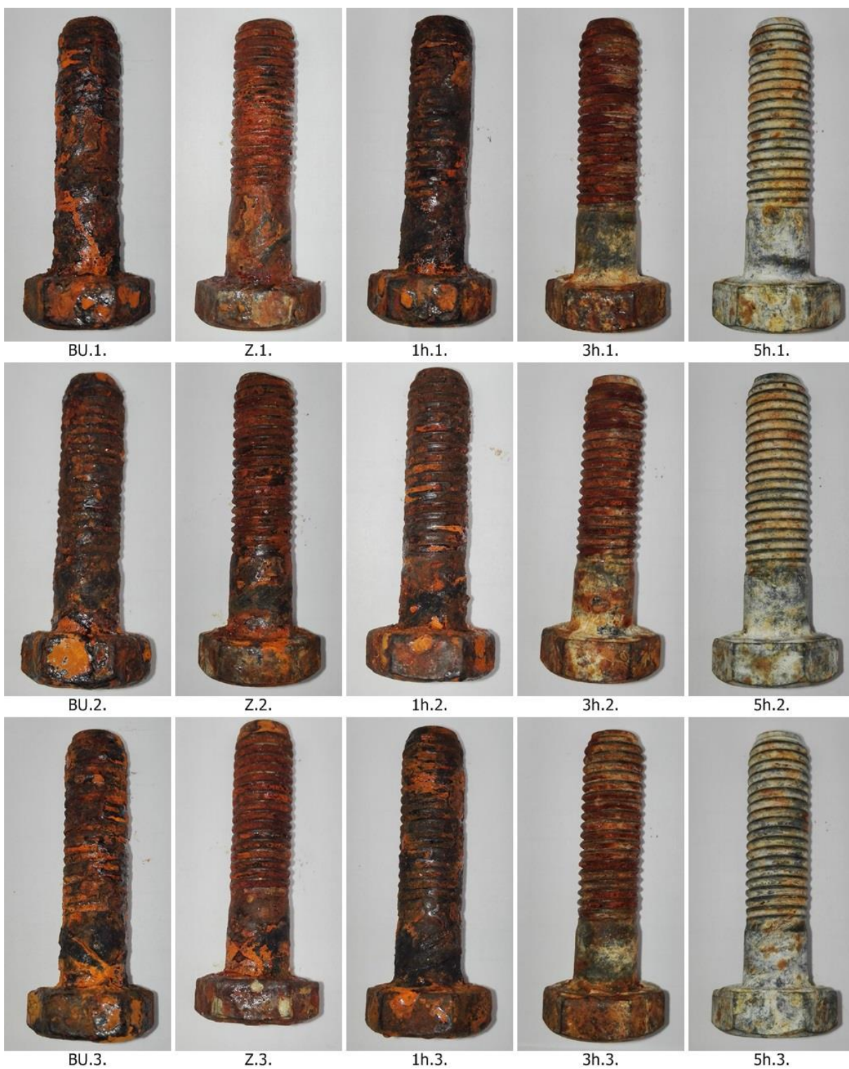
Obrázek 55: Vzorky po 264 hod v korozní komoře
