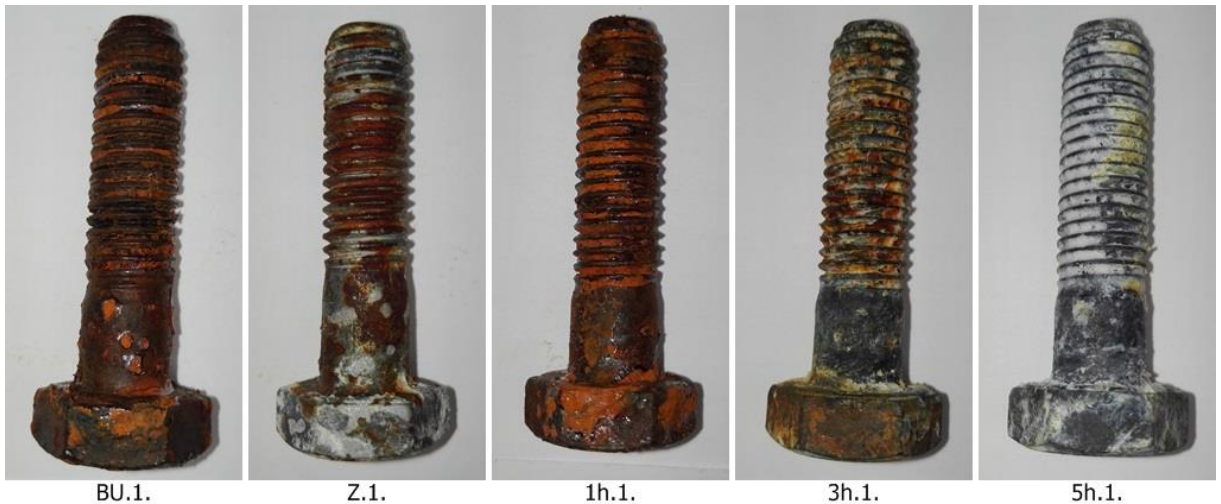
Obrázek 30: Vzorky po 72 hodinách expozice v solné mlze
