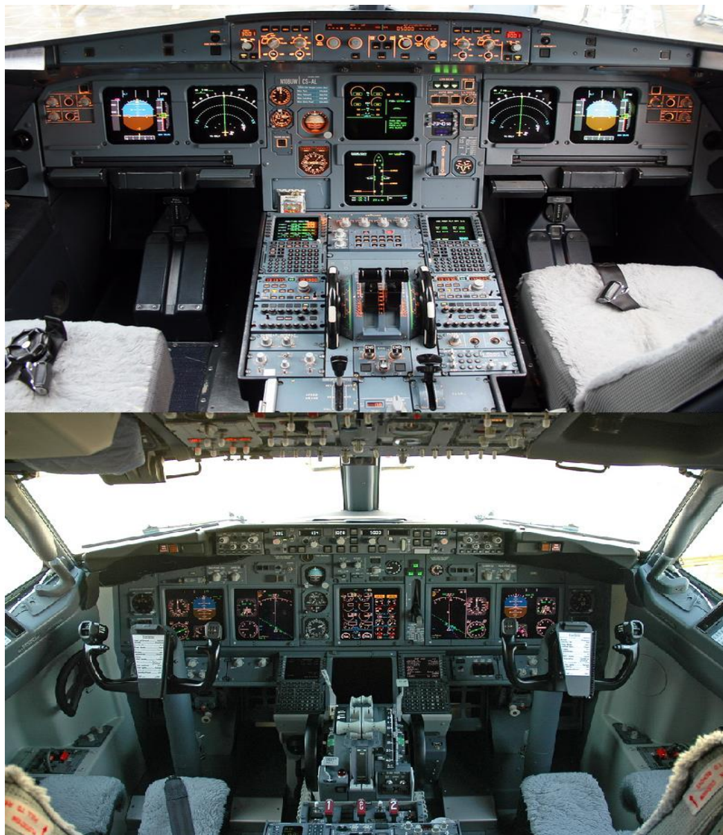
Obrázek číslo 39. Srovnání kokpitů A320 a B737.
