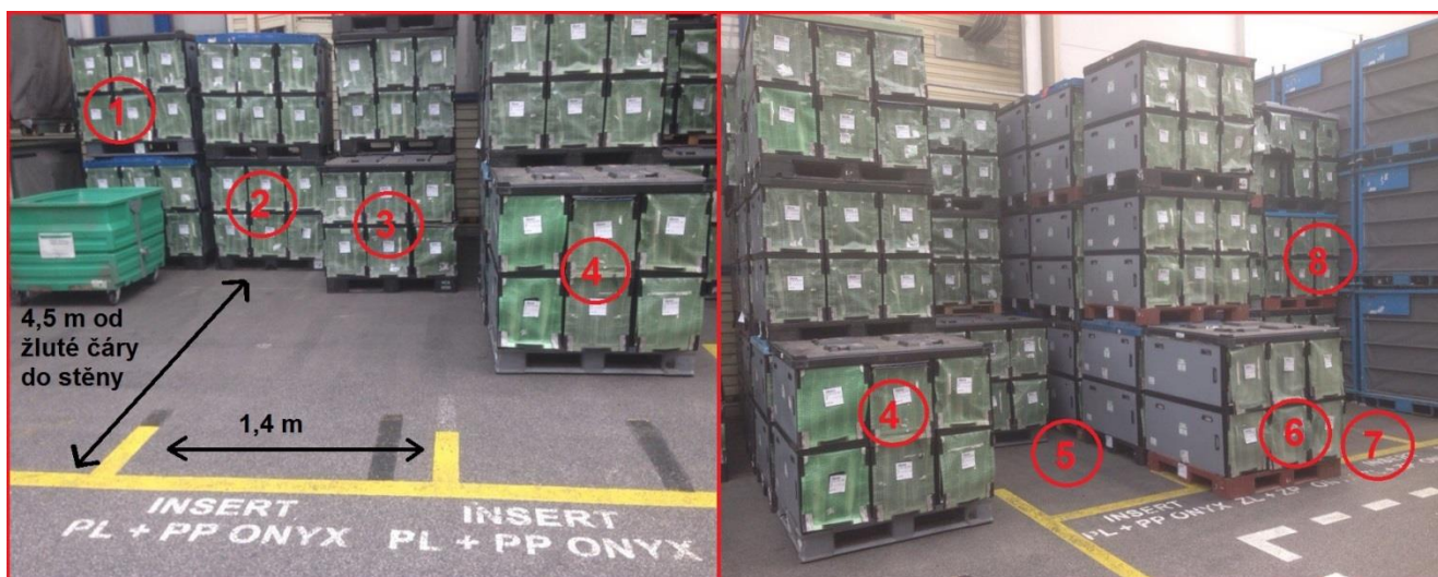
Obrázek 19. Sklad Insert s označením počtu řádků pro skladování a základní dimenze řádků.
