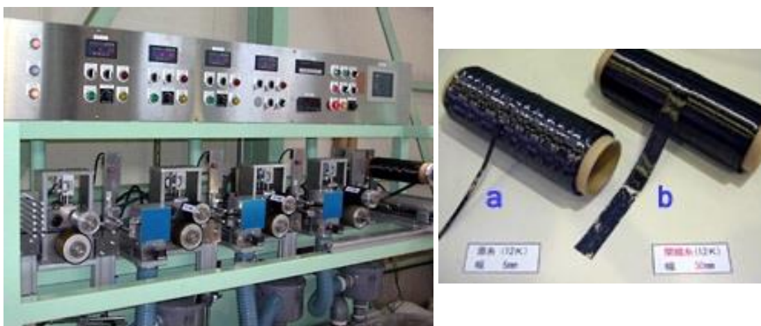
Obr. 30 – Spreadovací zařízení Harmoni Industry (vlevo), a) původní svazek, b) svazek po spreadu (vpravo) [30]
