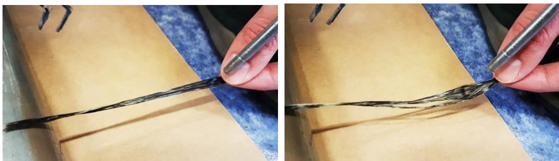
Obr. 40 – Roving před nasměrováním proudu vzduchu (vlevo), roving po nasměrování proudu vzduchu (vpravo)
