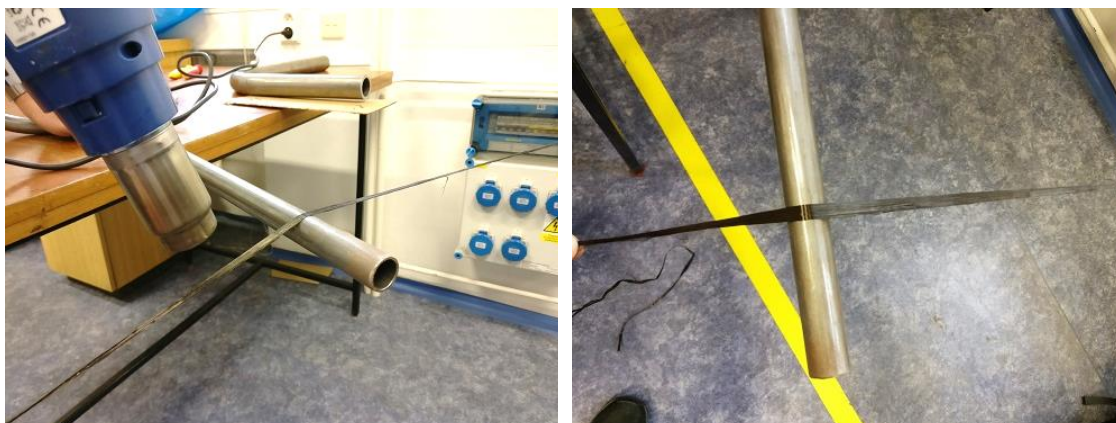
Obr. 37 – Nahřívání svazku horkovzdušnou pistolí (vlevo), spread po nahřátí (vpravo)
