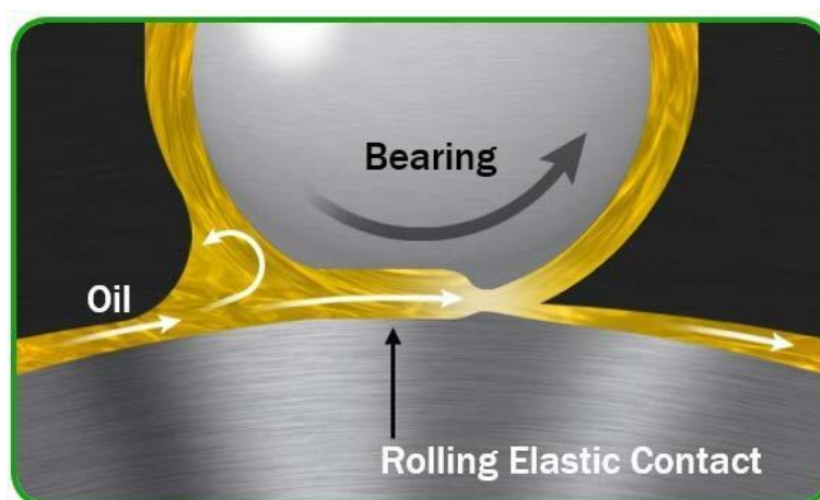
Obrázek 10: Elastohydrodynamický režim mazání valivého ložiska [19]
