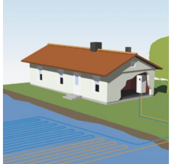
Obrázek 11 TČ voda/voda s využitím povrchové vody [25]
