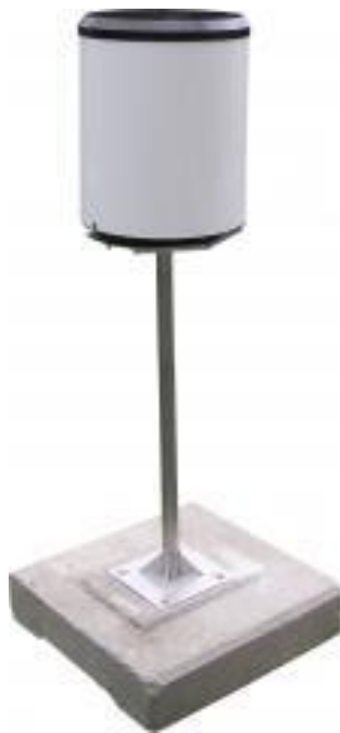
Obrázek 17: Pohled na srážkoměr včetně stojanu a základové betonové dlaždice [45]
