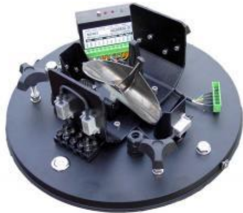
Obrázek 18: Pohled na vnitřní mechanismus srážkoměru [45]
