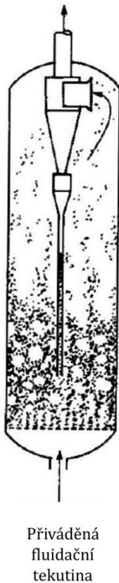
Obrázek 5: Stacionární bublinkující fluidní vrstva [8]
