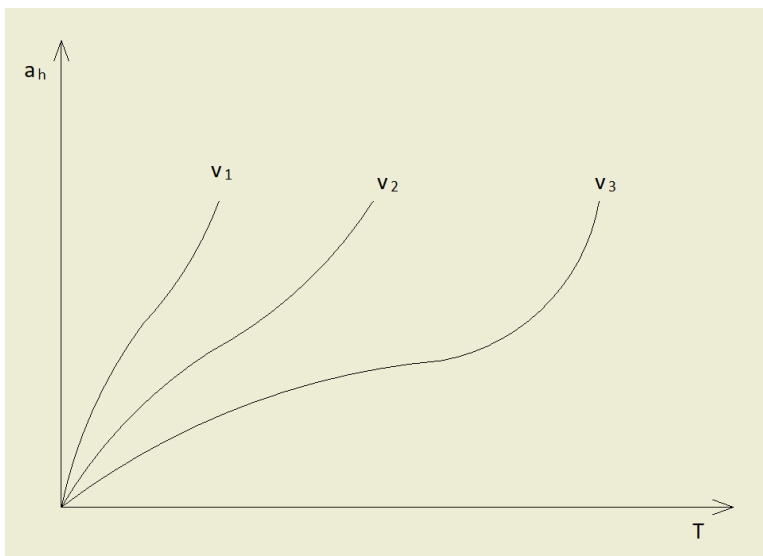
Obrázek 1: Stanovení trvanlivosti břitu pro dané kritérium opotřebení [vlastní tvorba]
