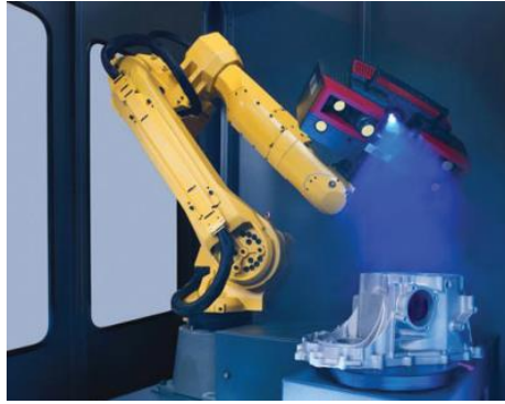
Obrázek 10: Použití automatizované inspekce pomocí 3D skeneru ATOS [10].
