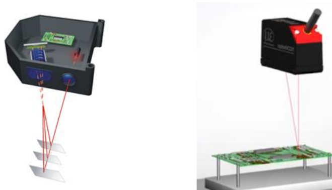
Obrázek 2: Konstrukční provedení komerčního laserového snímače a jeho aplikace. [4].
