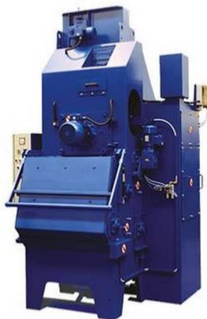
Obrázek 29, Bubnový tryskací stroj SmartLine T170R [36]
