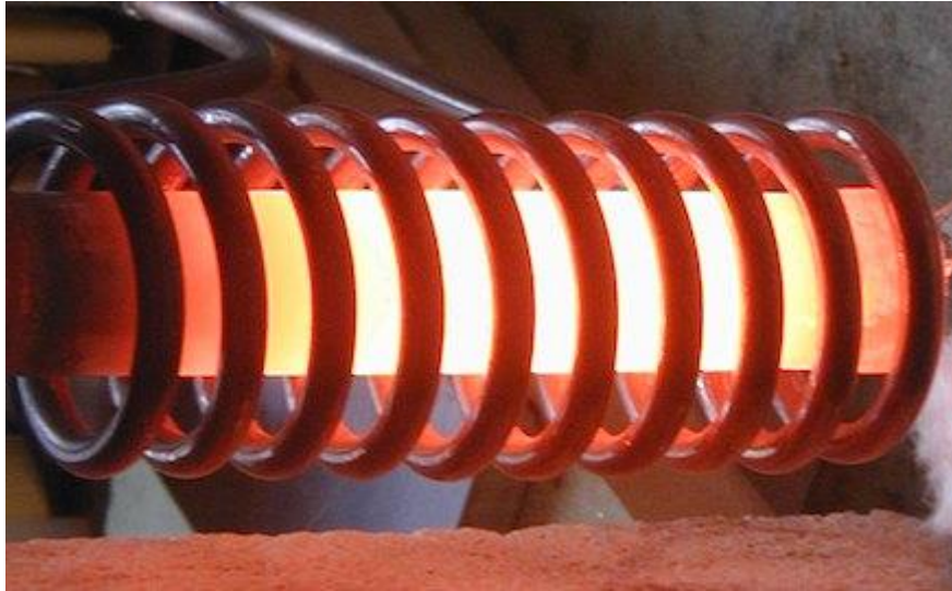
Obrázek 15, Indukční ohřev konce tyče [18]
