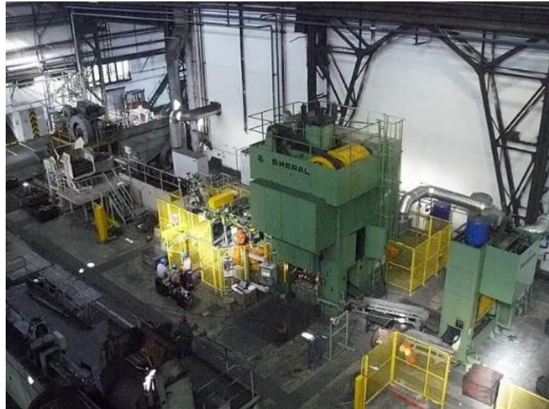
Obrázek 13, Kovací linka s klikovým lisem LZK 400 [23]
