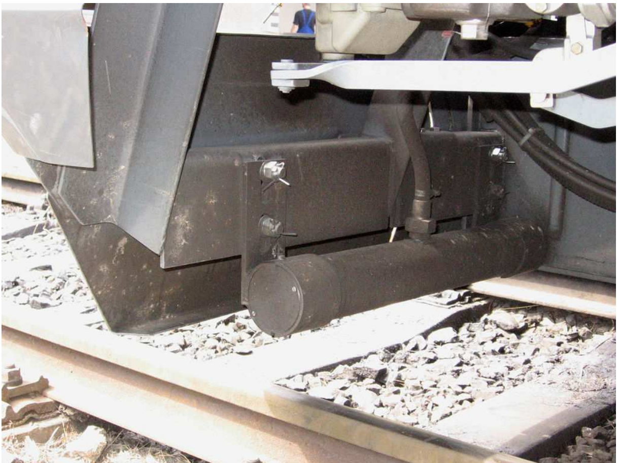
Obrázek 6 Indukční snímač systému LS instalovaný za smetadly kolejového vozidla (zdroj [21])
