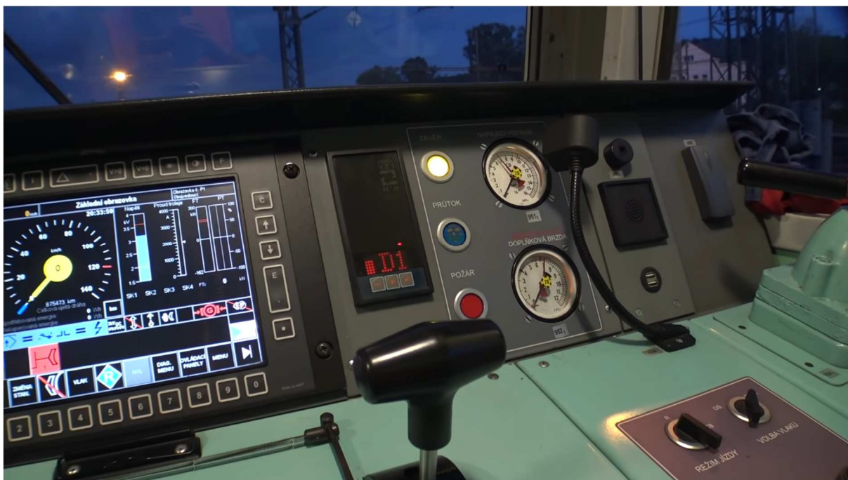
Obrázek 10 Návěstní opakovač zabezpečovače Mirel VZ 1 na stanovišti lokomotivy řady 363.5 při provádění diagnostického testu D1 po spuštění systému (zdroj [29])
