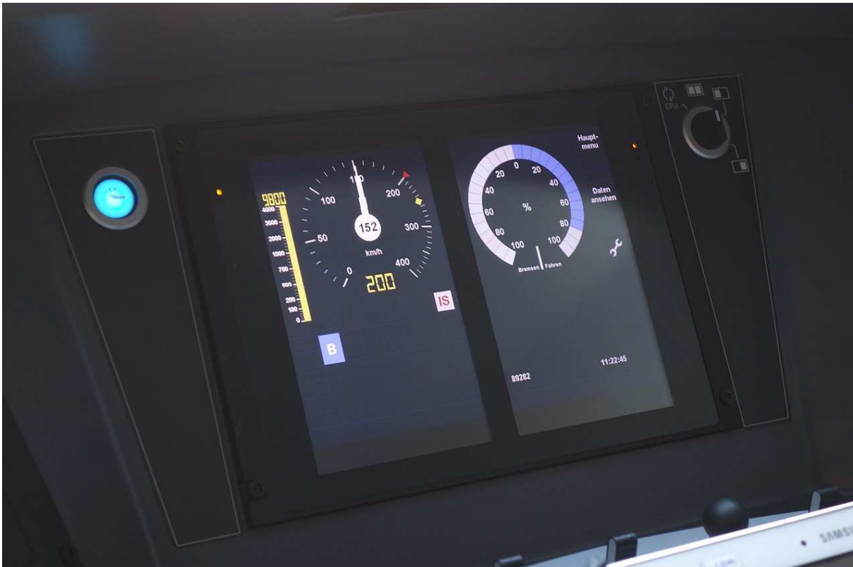
Obrázek 4 Indikace systému LZB na displeji na stanovišti strojvedoucího (zdroj [16])
