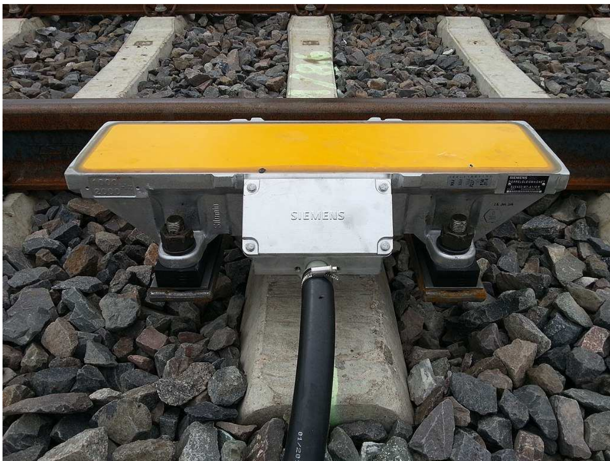
Obrázek 2 Přepínatelný traťový magnet systému PZB (zdroj [14])
