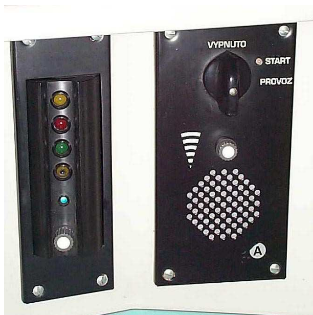
Obrázek 9 Návěstní opakovač a ovládací panel LS-90 na stanovišti strojvedoucího (zdroj [26])
