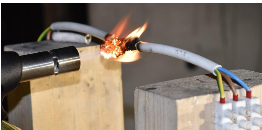
Obrázek 29: Charakteristický útvar vytvořený z materiálu pláště vzorku kabelu
