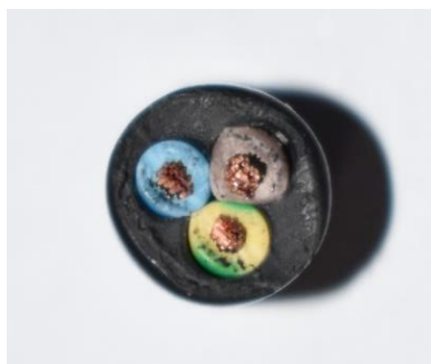
Obrázek 9: Řez silovým kabelem H05VV-F 3G 0.75mm 2
