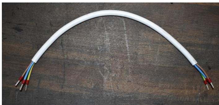
Obrázek 26: Příklad připraveného vzorku kabelu před vystavením tepelnému namáhání
